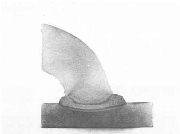
9. kép. Csaphegesztéssel készült kötés makrocisszolata (a csap elgömböjtése utáni állapotban).
