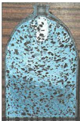
Az AGA massza minimálisra csökkenti a robbanás veszélyét, és biztonságot nyújt az acetilén felhasználóinak
