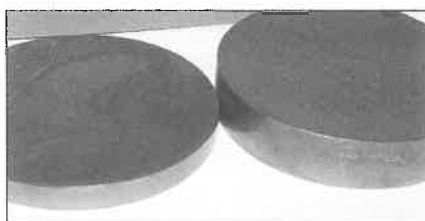
12. ábra. Gázplazmával vágott felület
