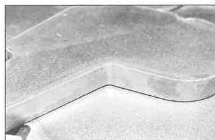
14. ábra. Lángvágó berendezéssel vágott felület
