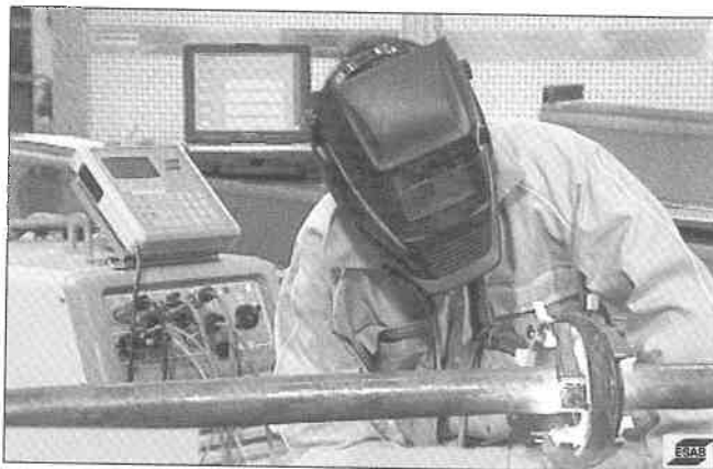
4. ábra. Minőségbiztosítási alkalmazás PROTIG 450 áramforrás, PRC hegesztőszerszám és számítógép segítségével
