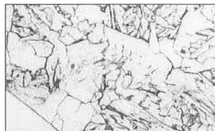
6. ábra. Ötvözetlen átmenet N: 300x, 3% Nital
