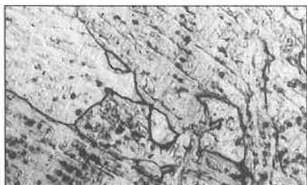
4. ábra. Felrakó hegesztés N: 300x Glicerines királyvíz
