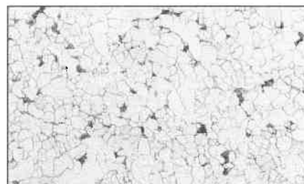
3. ábra. Ötvözetlen alapszövet N: 300x 3% Nital
