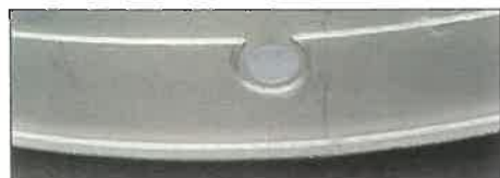
4. ábra. Porbeles huzallal hegesztett szerkezeti elem; szegélykiolvadásmentes, sima, lapos, szép varrat
