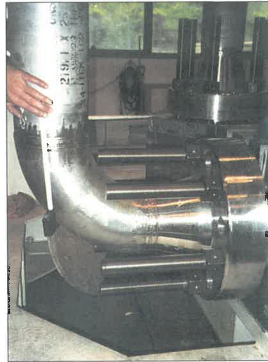
15. ábra. Csővezeték szegmens, 1.4462 duplex acélból, offshore berendezés számára
