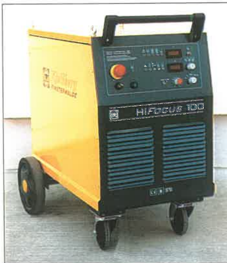
1. ábra. Kjellberg HiFocus100 plazmaáramforrás
