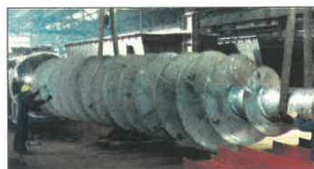
14. ábra. Szállítócsiga és ház, 1.4571 acélból a cellulózipar számára
