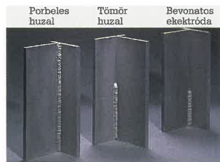
9. ábra. Azonos idő alatt hegesztett varrat hossza
