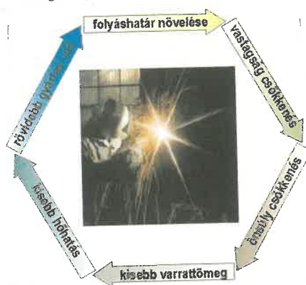
2. ábra. Nagyobb folyáshatárú acélok alkalmazásának hatása
