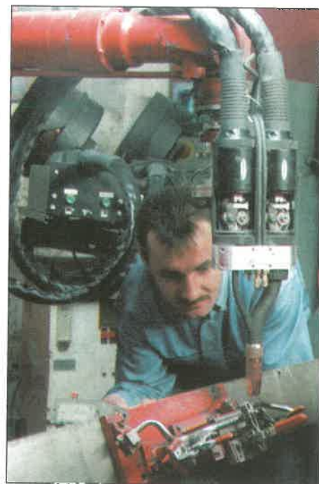
2. ábra. Fékcső hegesztéssel és forrasztással készített kötésére szolgáló készülék
