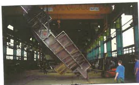
7. ábra. Kemence alsórész fordítása két daruval
