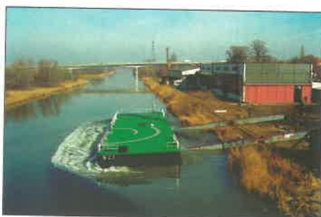
4. ábra. 200 t-ás ponton vízrebocsátása (Den Boer Hollandia)
