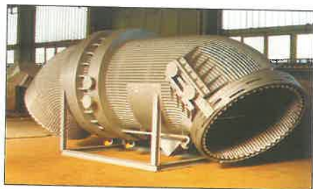
1. ábra. Vízhűtéses füstgázcsatorna (Krakatau Steel Indonézia)
