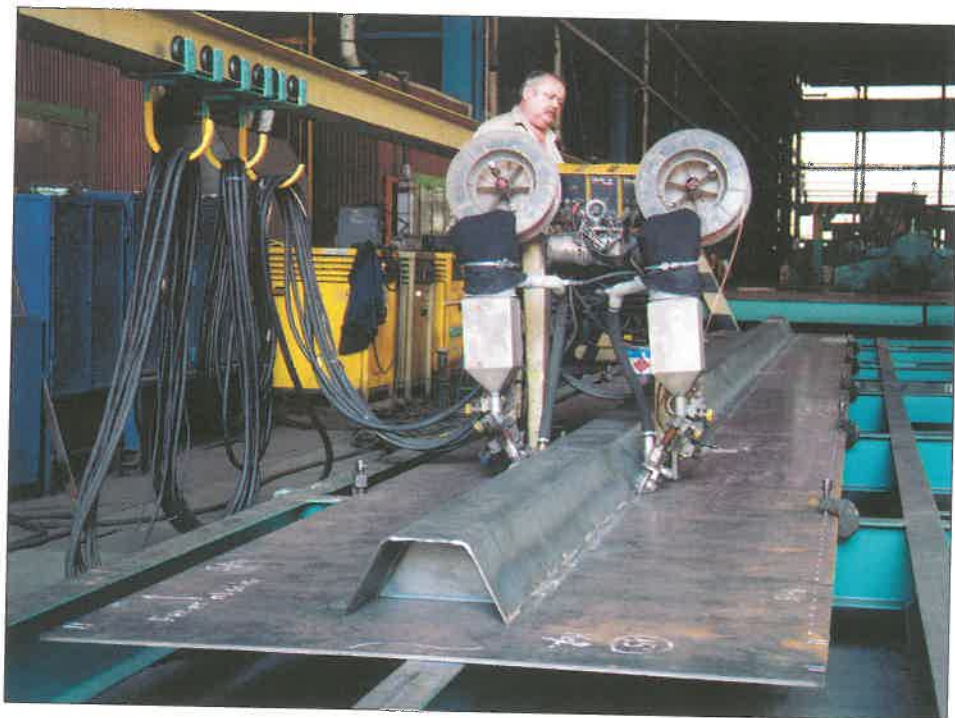
5. kép. Trapéz hosszmerítő hegesztése kétfejes fedett ívű hegesztő berendezéssel
