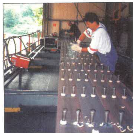
2. ábra. Csaphegesztés a kompozit-tartók sorozatgyártásánál
