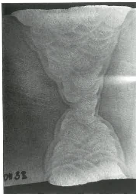
8. kép. Egy 100 mm vastag övlemez üzemi tompakötésének makro képe
