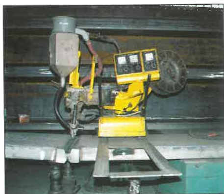
7. kép. Az övlemezek üzemi tompavarratának hegesztése fedett ívű eljárással
