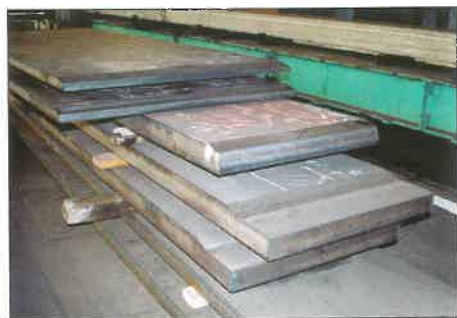
6. kép. Az alsó, 1200 mm és felső, 800 mm széles övlemezek varrat-él, ill. vastagság átmenet megmunkálás után
