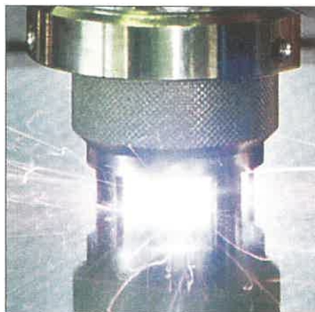
1. kép. Kondenzátor-kisüléses csúcsgyújtásos csaphegesztés
