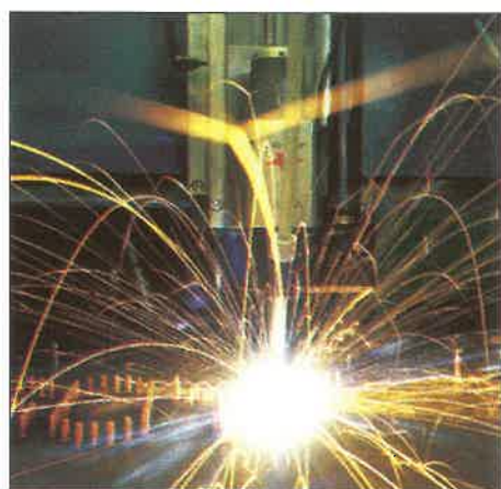
9. kép. Rövidciklusú ívhúzásos csaphegesztés
