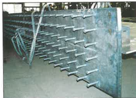
10. kép. A felső övlemezre hegesztett fejes csapok
