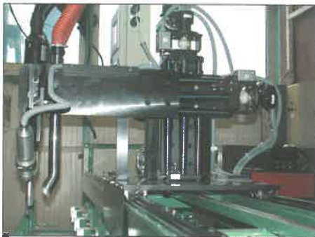
6. ábra. A hegesztőkonzolt hordozó automatikus keresztzsupport
