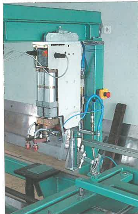
3. ábra. Az egyik hegesztő egység
