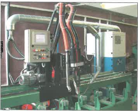
5. ábra. A hegesztőkonzol a kéthuzalos hegesztőpisztollyal, az elszívó csövekkel, a taktilis varratkövető szenzorral
