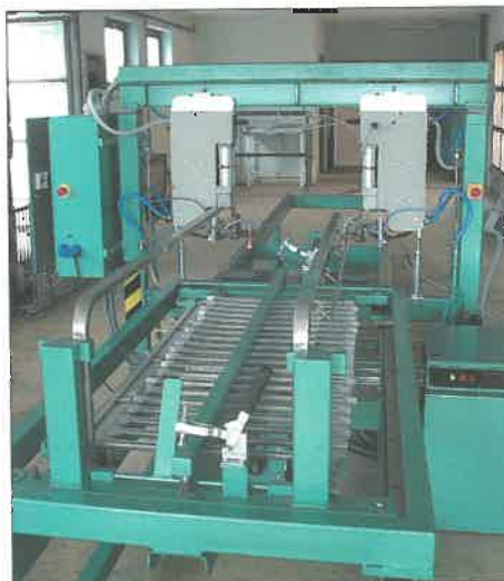
1. ábra. Programozható, automatikus pont- és dudorhegesztő célgép az elszívó és szűrőberendezéssel
