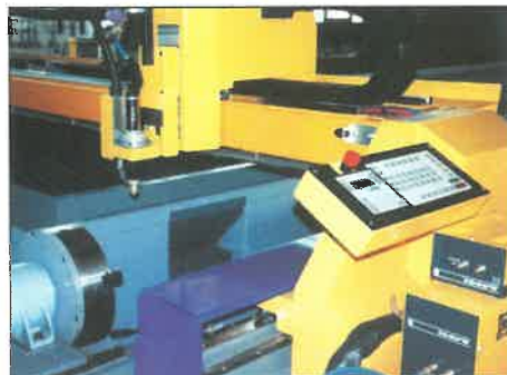
11. ábra. A plazmafej vágó helyzetben
