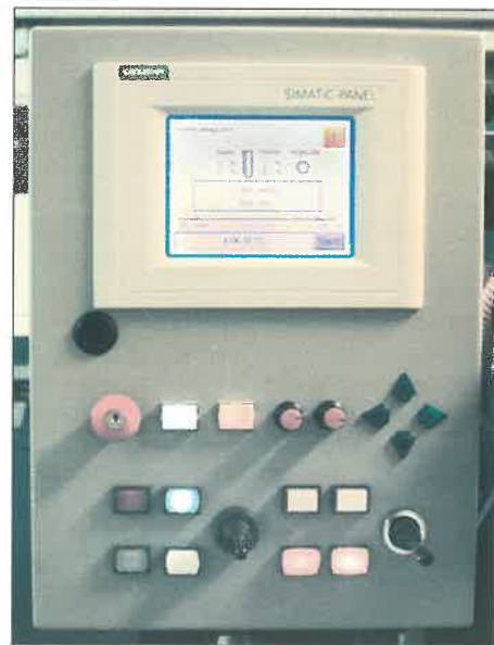
7. ábra. A célgép programozó-kezelő felülete, az alapfunkciók visszajelzésével és a joystickokkal
