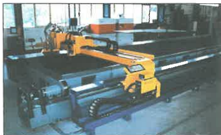
9. ábra. A híd a két lángvágó- és a plazmafejjel, az egyik oldali irányító pulttal. A vágócsatorna az elszívó szekciókkal és a forgató berendezéssel
