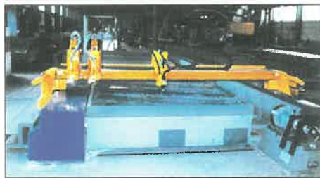
10. ábra. A CNC vágóközpont a lemeztár felől
