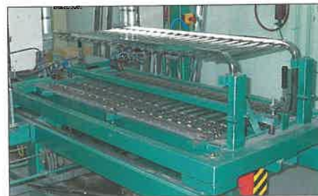
2. ábra. Gázélasztós hegesztőkészülék egy berakott munkadarabbal
