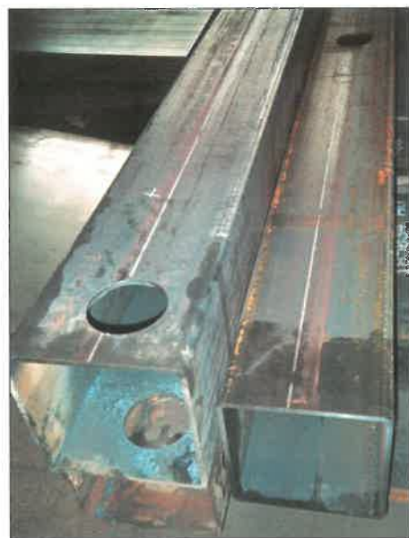
12. ábra. Készrevágott zártszelvények
