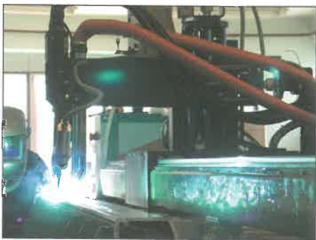
4. ábra. A kamrahegesztő célgép a próbahegesztések idején
