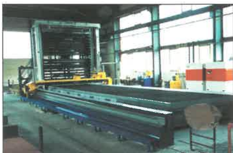
8. ábra. A vágóközpont az automatikus lemeztárral, a vágóasztallal és a vágócsatornával
