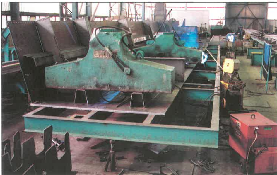
5. kép. Egy fenéklemez-gerinc panelegység nyakvarratának és kereszt-merevítőinek hegesztése MAG eljárással
