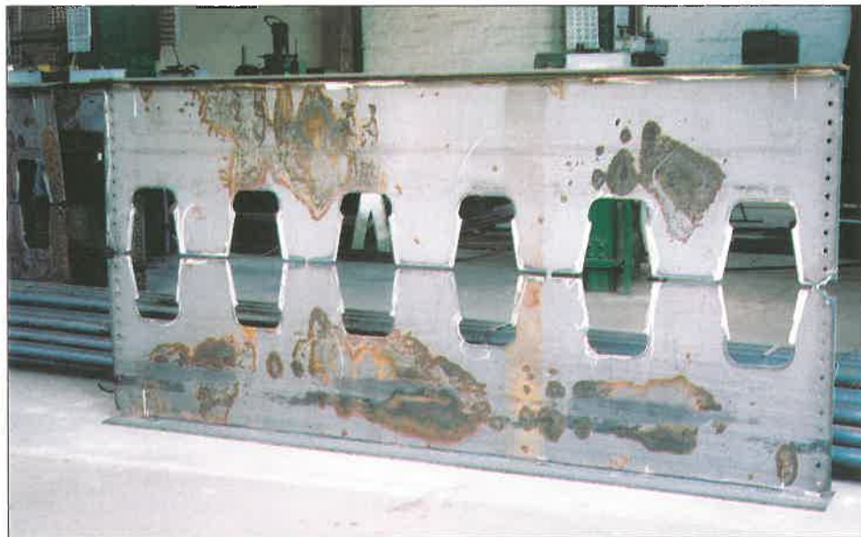
4. kép. A két (négy hőhíddal még összefogott) keresztmerezítő, felhegesztett övlemezekkel és az NF-csavaros gerincillesztések előfűrt lyukaival
