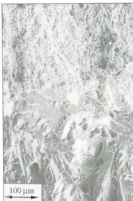
7. ábra. Hajlított próbatest töret felületének elektromikroszkópos képe az új módszer szerinti plattírozásnál a töret felület egészséges szerkezetű a hőhatás övezetben és képlékeny törés nyomait mutatja a heganyagban
