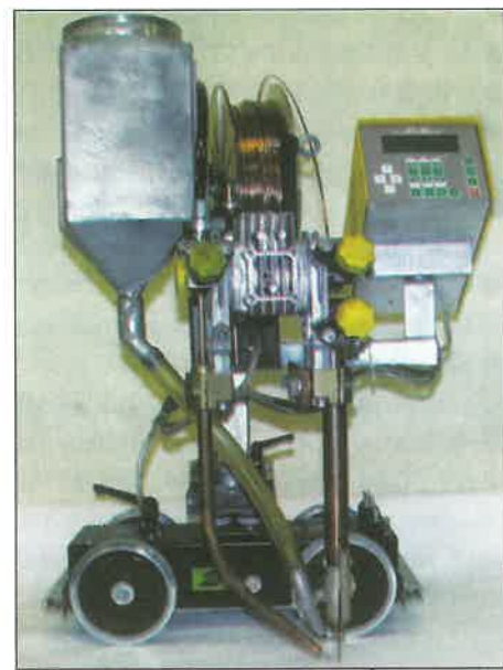
1. ábra. Fedett ívű hegesztő berendezés (ESAB A6 Mastertrac) szinergikus hideg huzal adagoló készülékkel
