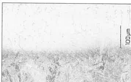
5. ábra. Az első réteg (alul) és a második réteg (felül) átmeneti zónájának mikroszerkezete az új módszer szerinti plattírozásnál
