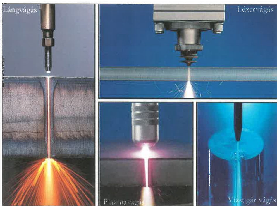
1. ábra. Az ipari gyakorlatban alkalmazott termikus- és vízsugaras vágás [2]
