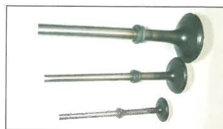
4. ábra. Dörzshegesztett motorszelepek, gallérral
