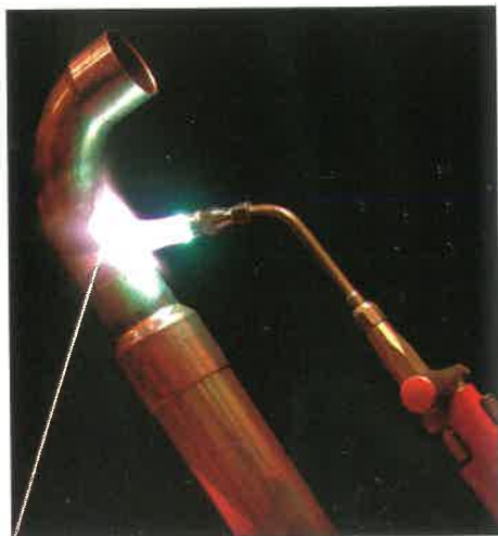
1. ábra. Rézdarabok forrasztása folyasztószer nélkül a CuP-forrasztóanyag segítségével
