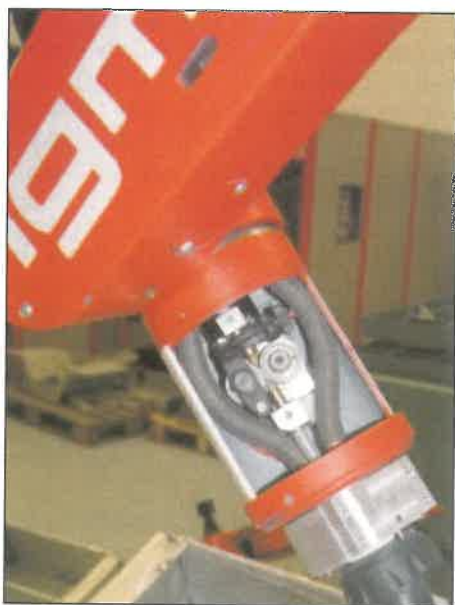
6. ábra. Kompakt huzalelőtő egység
