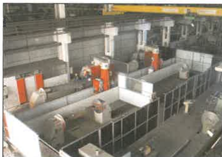
1. ábra. RT 330 típusú ívhegesztő robotrendszer az Aprítógépgyár Rt.-ben
