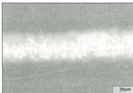
12. ábra. ZnAl5-tel keményforrasztott AlMg4.5; ultrahangos mechanikai aktiválás
