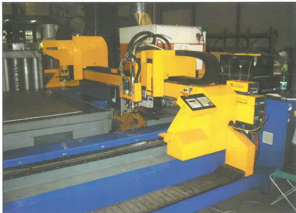
2. ábra. Többfunkciós CNC vágóberendezés forgató berendezéssel, finomsugaras és hagyományos plazma áramforrással és CNC fúrófejjel
