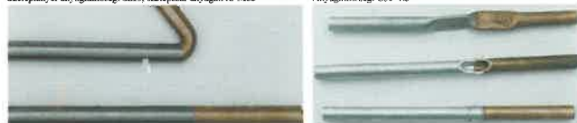
Alumínium+vörösréz A cső mérete 10x1,5 mm, sajtoló lapított, metszet, kész darab
