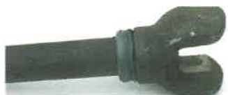
Gépjármű féltengely, heg. átm.: 24 mm, Am.: C45+Cr1
