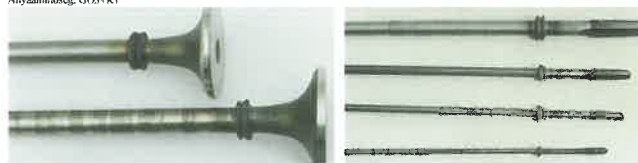
Anyamenetfűrészek Hegesztett átmérők: 11, 8, 6,5, 5 mm Anyagminőség: C60+R3
