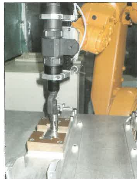
7. ábra. PSW gépi pisztoly VTS-csatlakozó felülettel és kiegyenlítő szánnal egy roboton
