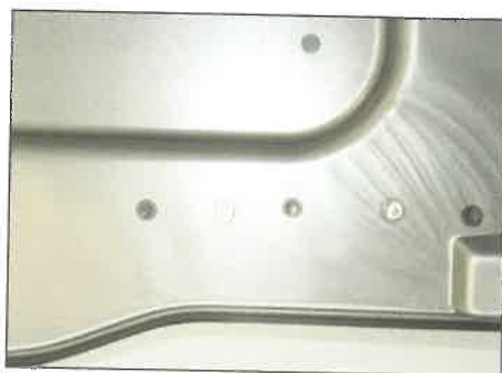
9. ábra. Két plazma pont egy sorban három ellenállás ponthegeztett kötessel
