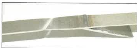
9. ábra. Hegesztett próbatest szakítás után
