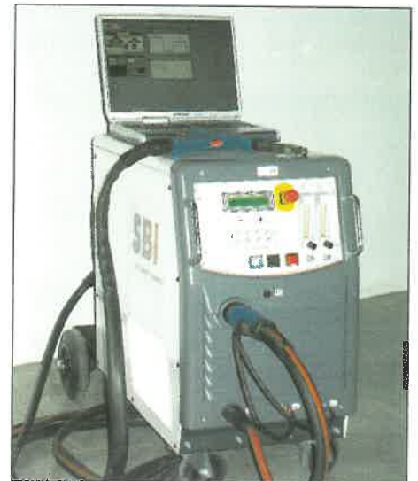
2. ábra. PSW gépfelépítés kézi plazma ponthegesztő pisztollyal
