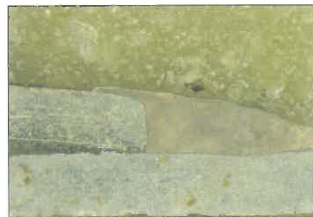
7. ábra. Gépesített keményforrasztás metszete
