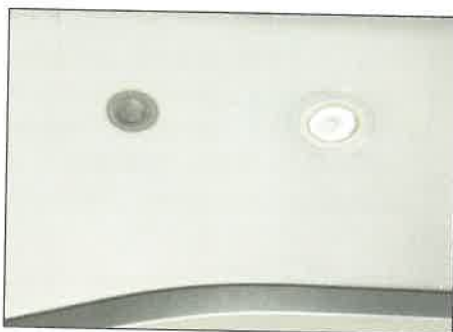
10. ábra. A pont felületek összehasonlítása, balra az ellenállás, jobbra a plazma ponthegeztett kötés
