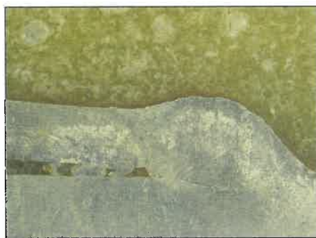
6. ábra. Gépesítve hegesztett varrat metszete
