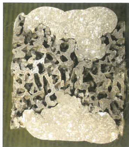
11. ábra. TIG-hegesztéssel készített, nem teljes beolvadású varrat metszete
