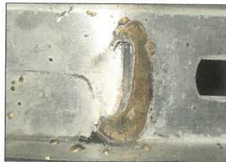
4. ábra. A forrasztott kötés törésmenetele
