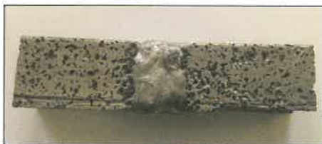
10. ábra. TIG-hegesztéssel készített varrat
