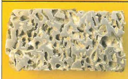
25. ábra. Diffúziós hegesztéssel készített kötés és annak makroszerkezete
