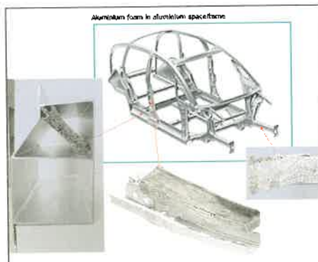
3. ábra. Gépjármű felépítmények merevítő-kitöltőanyaga
