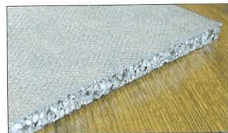
6. ábra. Fémhabbal töltött, rozsdamentes acélborítású esztergapad alap
