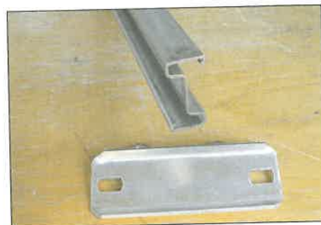
2. ábra. Szerkezeti elemek ívforrasztáshoz
