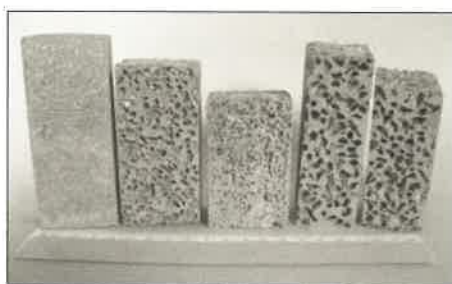
9. ábra. Különböző sűrűségű fémszivacsok
