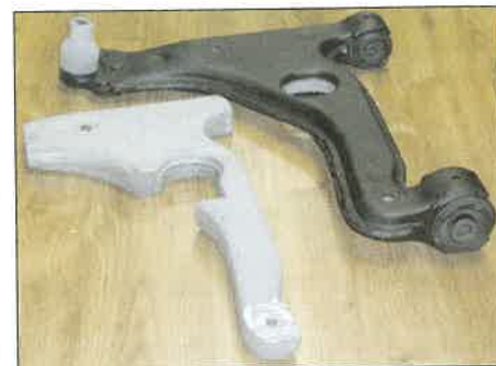
4. ábra. Trapézkar habosított fémbéléssel
