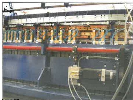
4. ábra. Álló- és mozgó elektróda rendszer
