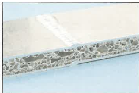
12. ábra. TIG-hegesztés alkalmazása fémhab szendvicsszerkezeteken
