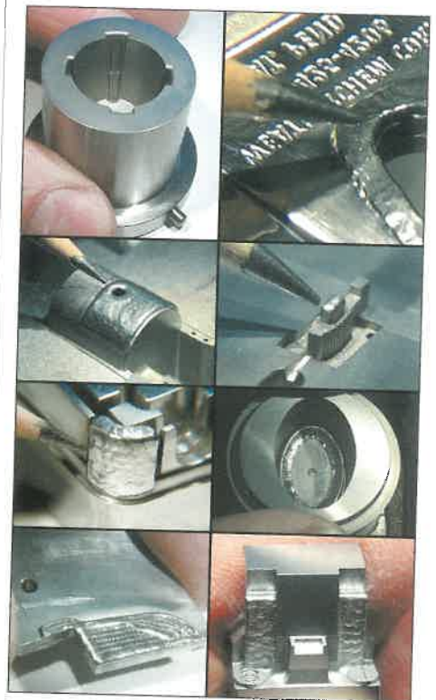
7. ábra. Precíziós fröccsöntőszerszámok lézersugaras kötő- és felrakóhegesztése
