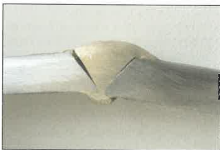
4. kép. Repedt t=7,1 mm méretű próbatest
