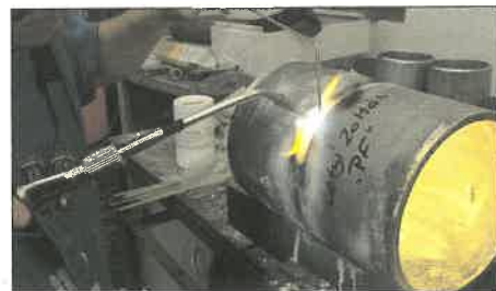
1. kép. Horganyzott cső keményforrasztása
