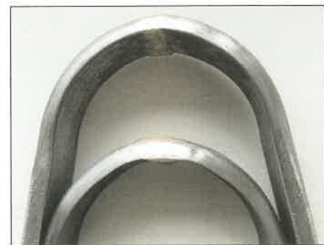
2. kép. Repedésmentesen meghajlított próbatestek
