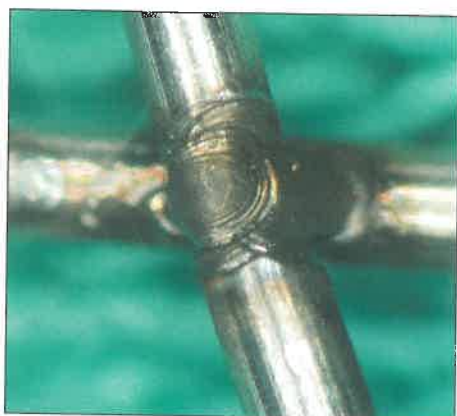
10. ábra. Nikkelhuzalok lézersugaras csomóponti varrata (sztentekhez)
