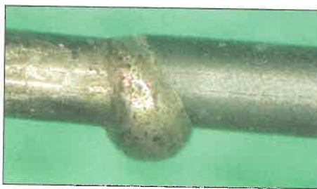
12. ábra. 0,9 mm vastag dumethuzal és sárgaréz huzal tompavarrata
