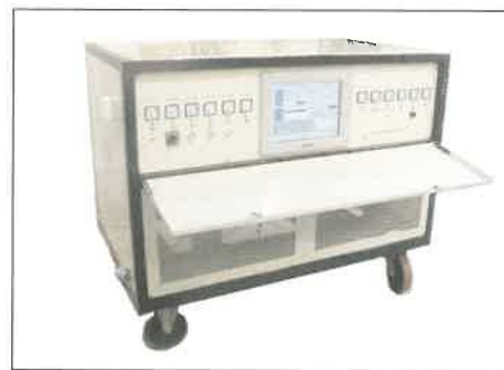
18. ábra. 12 csatornás, digitális vezérlésű varrathőkezelő berendezés
