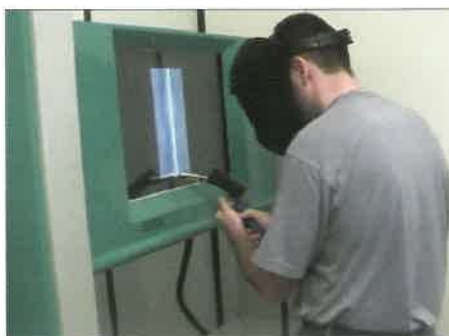
Fogyóelektródás védőgázás kézi ívhegesztés szimulációja függőleges helyzetben
