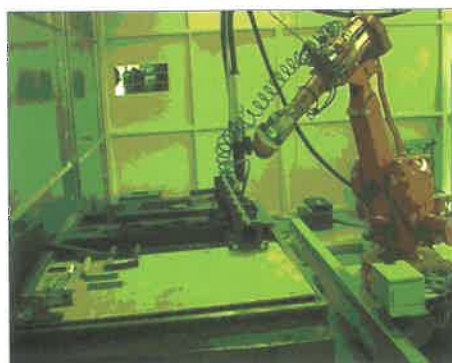
2. ábra. Lézeres csőhegesztés robotos munkahelye
