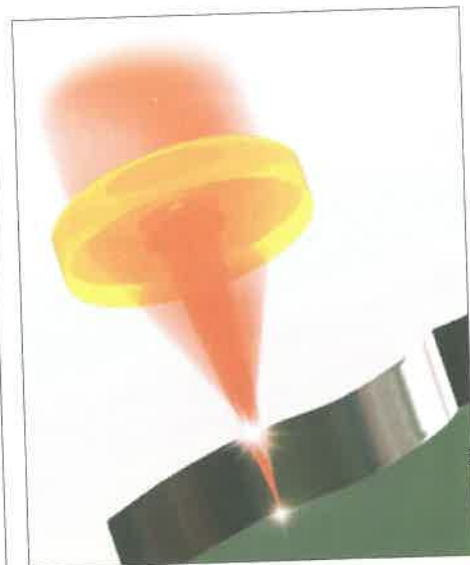
18. ábra. Az Air Liquide cég kettős fókuszos lézervágása
