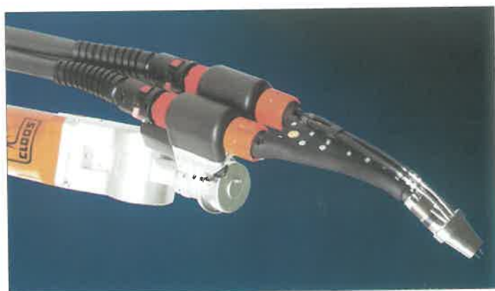
3. ábra. A CLOOS cég kéthuzalos tandem hegesztőfeje
