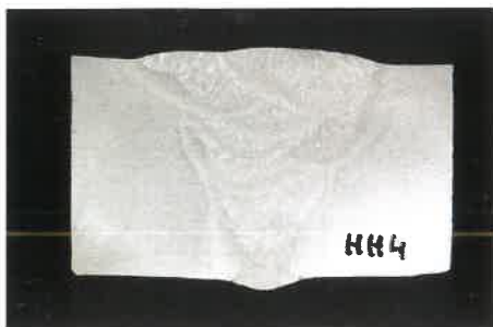
8. ábra. Hideghuzalos fedett ívű automatával készült hegesztett kötés
