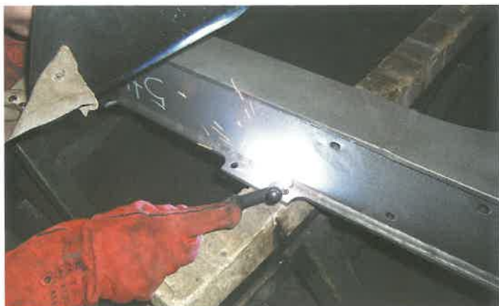
2. ábra. TIG-utókezelés gyakorlati alkalmazása (hozaganyag nélkül)
