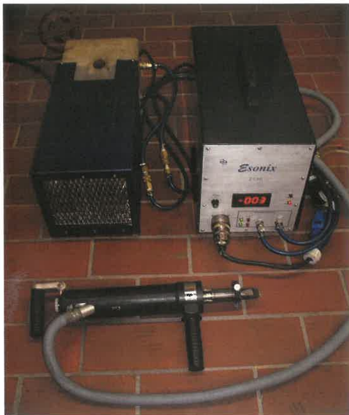
5. ábra. A komplett UIT-berendezés (UH-generátor, hűtőberendezés, megmunkáló fej) [10]
