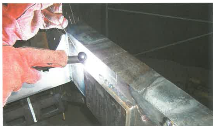
3. ábra. A TIG-utókezelés gyakorlati alkalmazása (hozaganyaggal)
