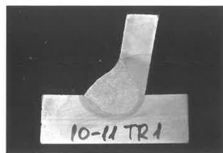
13. ábra Trapézborðák nyakvarratáról készült makrofelvétel; Fedett ívű hegesztés leélezéssel
