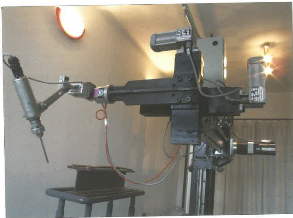
1. ábra. Motoros keresztcszán a taktilis szenzorral.
