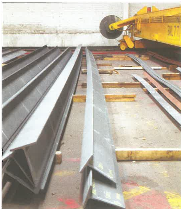
3. ábra Egy T merevítőn látható hosszirányú görbület.
