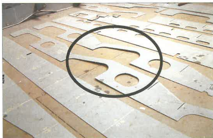
1. ábra. Két 4 mm vastag munkadarab (a képen bekarikázva), amelyek a vágást követően lényeges elmozdulást (deformációt) mutatnak.
