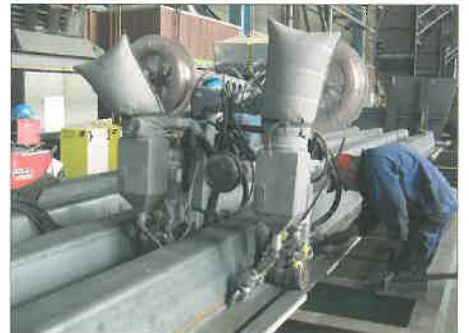
1. ábra A trapézbordák nyakvarratainak hegesztése vízszintes helyzetben kétféles fedett ívű automatával
