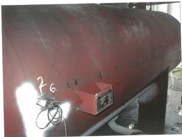
2. ábra. Csillapodás és sebesség mérés fekvő hengeres ammónia tartályon
