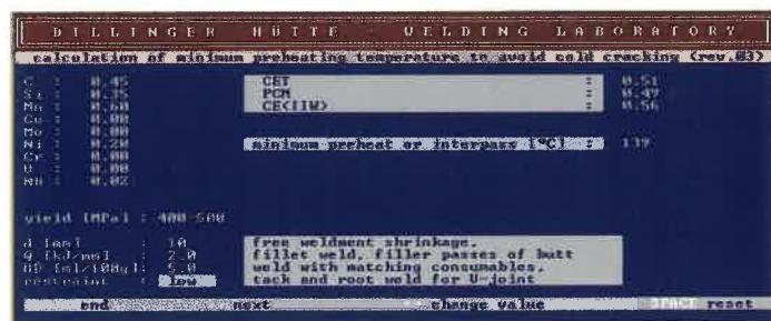
7. ábra. Dillinger Hütte (GTS) által kifejlesztett előmelegítési hőmérsékletet számoló program adatlapja
