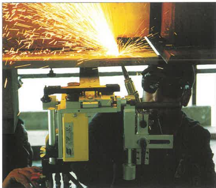
14. ábra. A híd és – nem utolsó sorban – a varratalak terv szerinti méreteinek biztosítása mindenütt helyszíni méretre szabással történt
