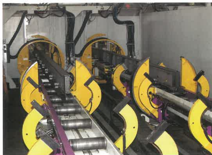
4. kép Görgőpályákon kerül a két megfűzött hossztartó a hegesztőkabinba, ahol hidraulikus berendezés rögzíti azokat
