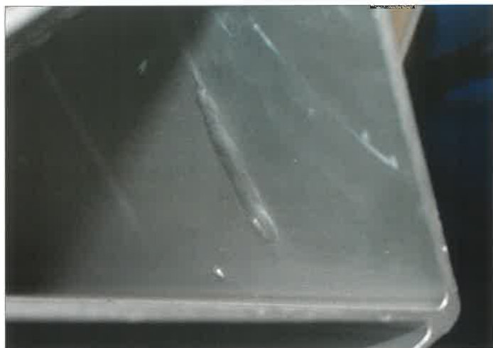
10. ábra Túlhevülés okozta átrokadás és beszívódás a gyökoldalán
