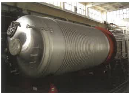
Vegyipari berendezés helyszínen felületkezelve (pácolva, passziválva)
