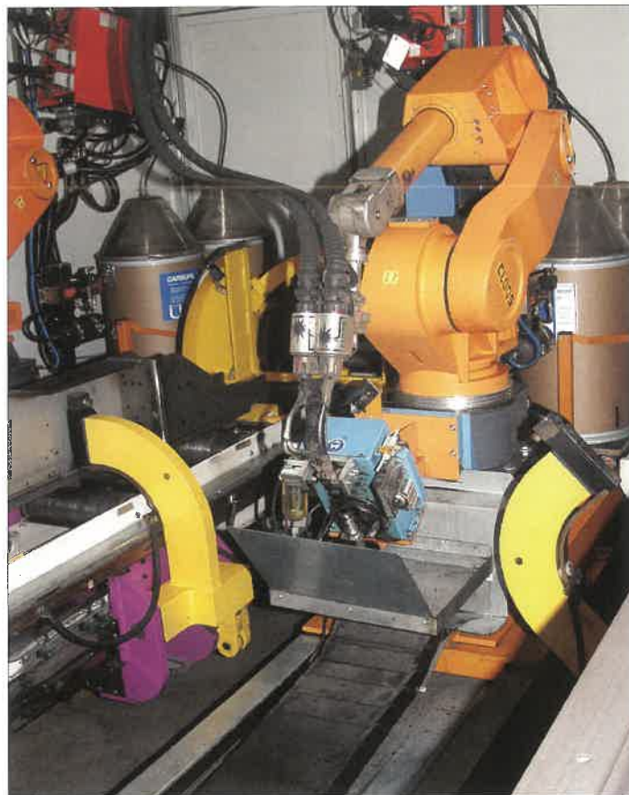
6. kép Az egyenletesen jó hegesztési eredményeket szolgálja az automatikus hegesztőegő tisztító berendezés
