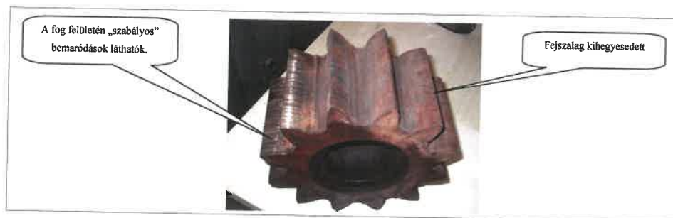
2. ábra A károsodott meghajtott fogaskerék.
