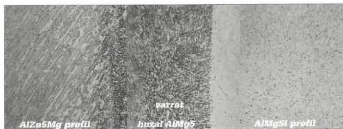
2. ábra Nemesített alumínium profilok hegesztett kötésének szövetszerkezete (AlZn5Mg - 7108 és AlMgSi - 6063)
