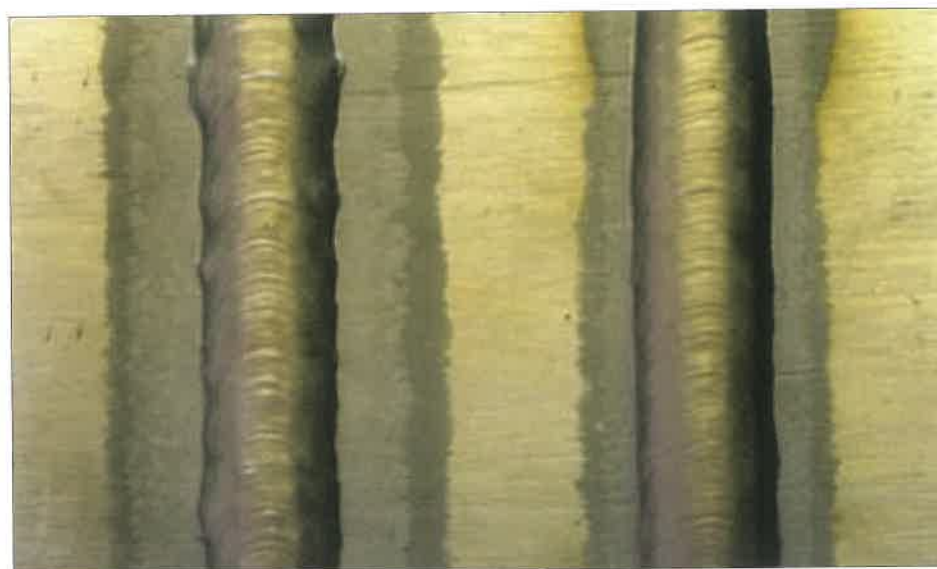
10. ábra 4.6 minőségű argonnal (bal oldal), ill. azonos minőségű 300 ppm (0,03%) oxigént tartalmazó argonnal (jobb oldal) fogyóelektródás technológiával készített tompavarrat képe alumínium esetén [5]
