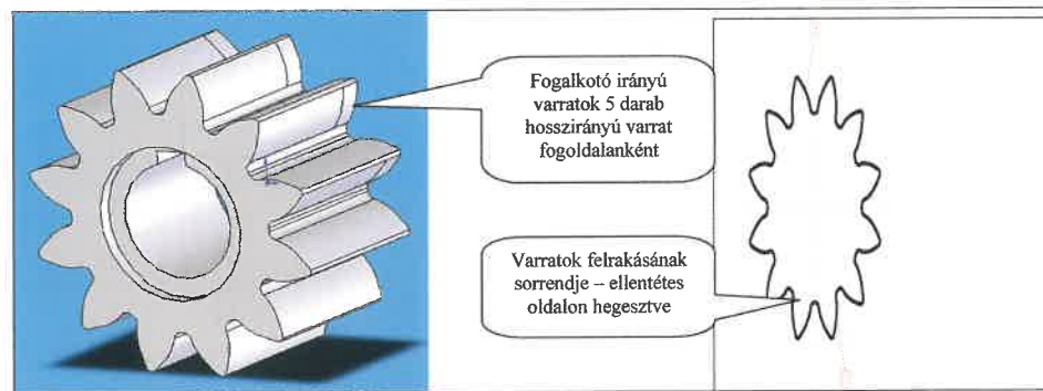
4. ábra A varratok elhelyezése és a felhegesztés sorrendje.
