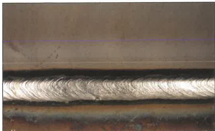
15. ábra 316L típusú Ø 3.2 mm átmérőjű CRISTAL™ elektródával hegesztett varrat
