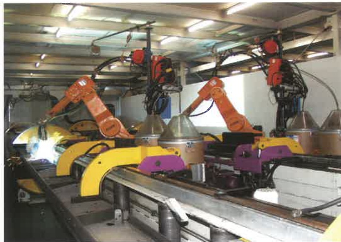
2. kép Kevesebb mint tíz perc alatt hegeszti meg a két robot az utánfutó 13,6 m hosszú hossztartóját
