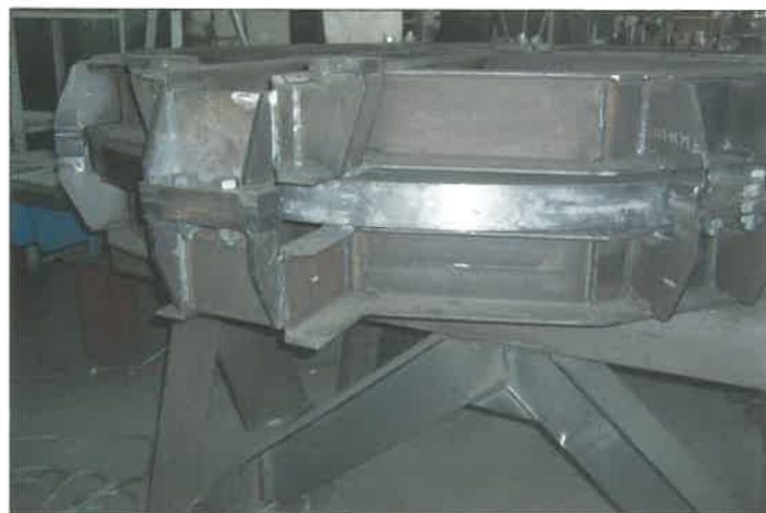
3. ábra. A fogaskoszorú szegmensek toldásához alkalmazott készülék
