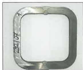
6. kép. Külső és belső varratok csiszolati képe
