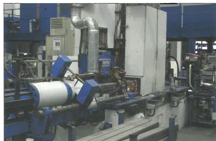
9. kép. Schlatter leolvasztó tomphahegesztő gép
