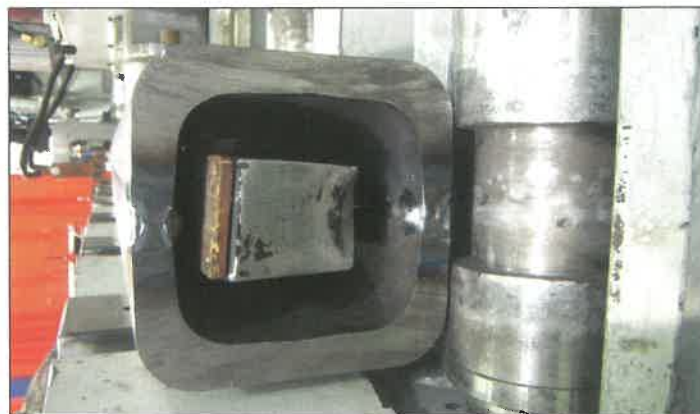
7. kép. Fedőporos szimplahuzalos belső varratozó
