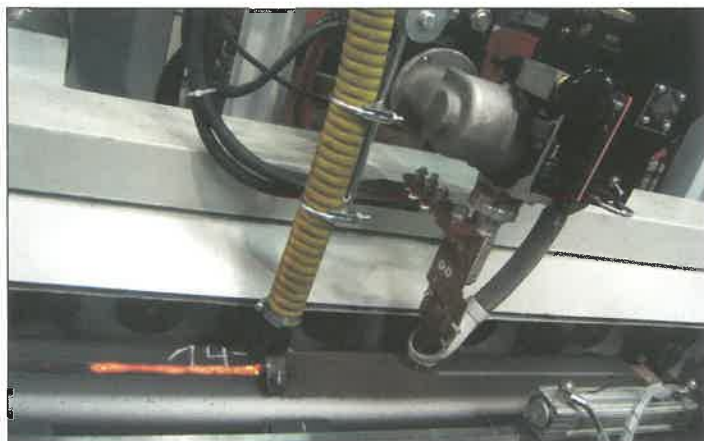
5. kép. Fedőporos ikerhuzalos külső varratozó
