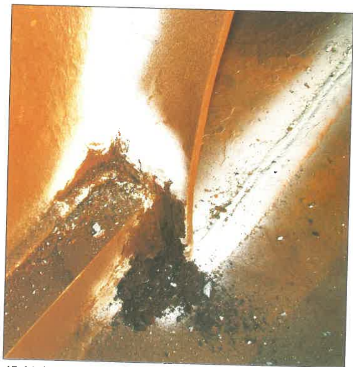
15. felvétel Sarok-zugok iszapjára felhordott mágneses repedésvizsgáló alapoza. (Az iszap nem mutatott „repedést”!?)
