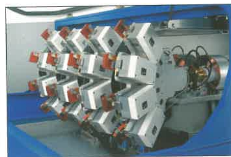
8. ábra. A lézer forrása: a sorba kapcsolt dióda blokkok
