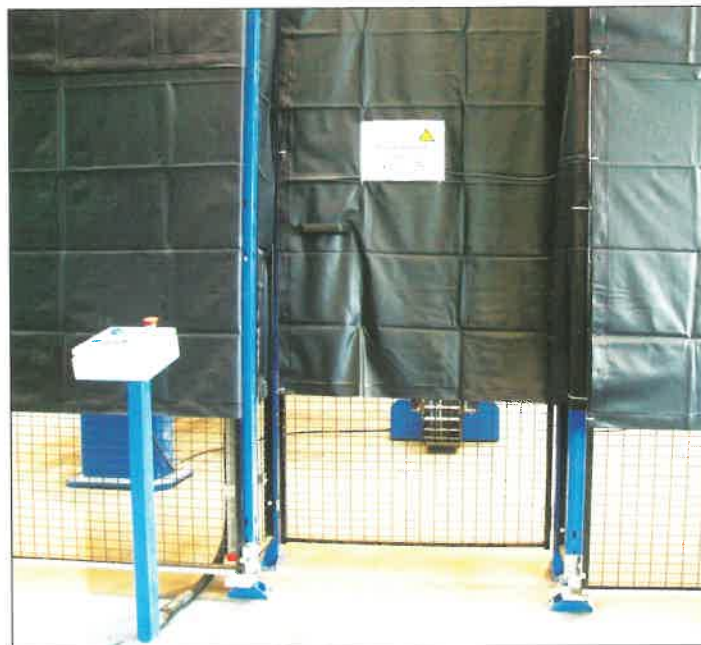
4. ábra. Villamoson figyelt védőajtók és kezelőpanel (jobb és bal oldalon a ki- és berakáshoz, középen szervizajtó)
