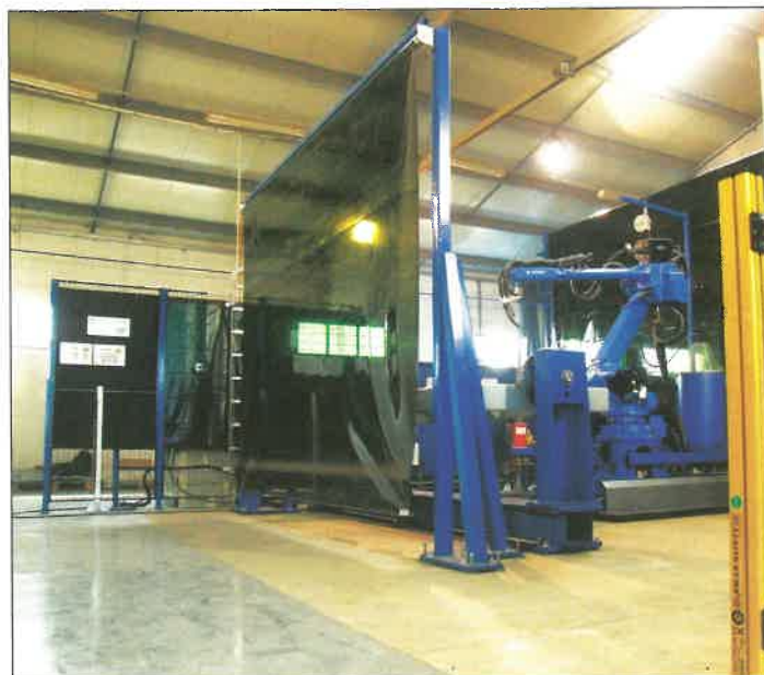
5. ábra. Védőkerítések, védőfüggönyök, fénysorompók
