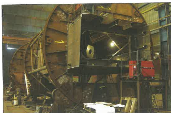
5. ábra A főtartó gyártása a forgatókészülékben
