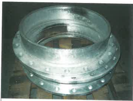
3. kép: Jól látszanak tűzhorganyzás után is a kőszerű nyomai
