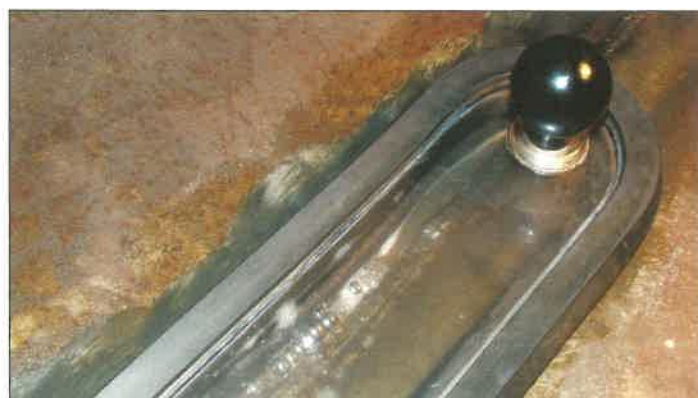
10. felvétel Videóból kivett kocka. A hidegkötéses ömledék „mellé-tett” varratát nem vitték tovább, így 10 cm hosszon egybefüggő az „átjárhatóság”!
