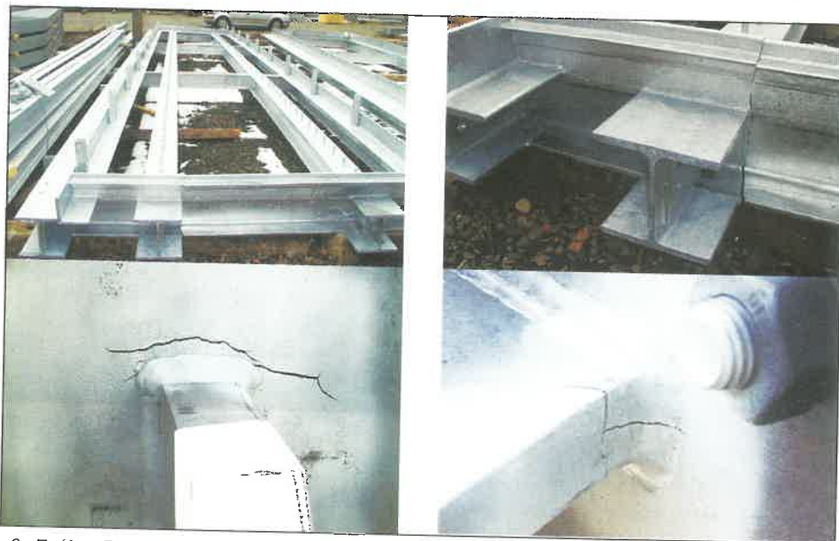
6–7. ábra Egy merev balkon keretének károsodása (lásd baloldali képet) a nagy feszültség miatt, amely galvanizáláskor kettős bemeletés után keletkezett
