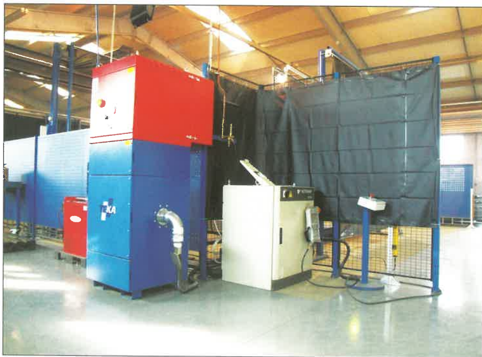
1. ábra. Áramforrás, szűrő, robotvezérlés, kezelőfelület
