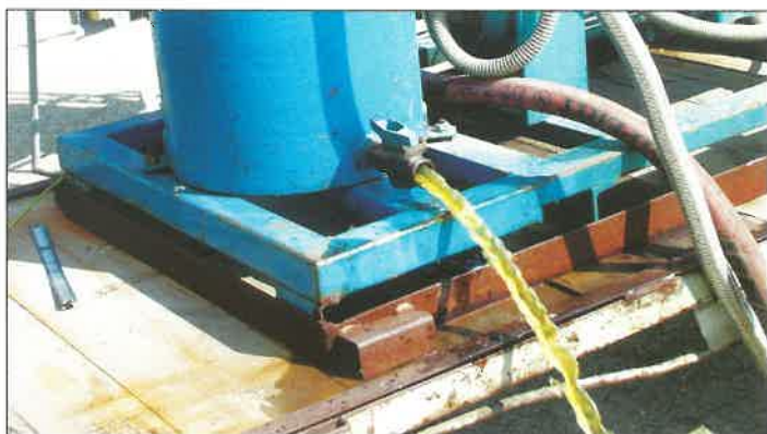
7. felvétel Tiszta gázolaj a vákuumszivattyú cseppfogója felső rétegéből.
