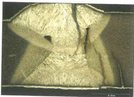
1. ábra A tompakötésnél az alapanyagban, a varratfémben és a hőhatásövezetben található cinkkel feltöltődött repedések
