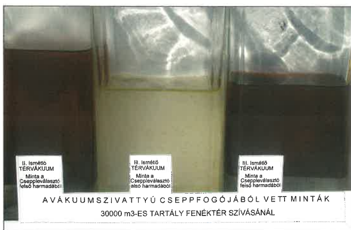
8. felvétel. A cseppfogóból vett rétegminták.
