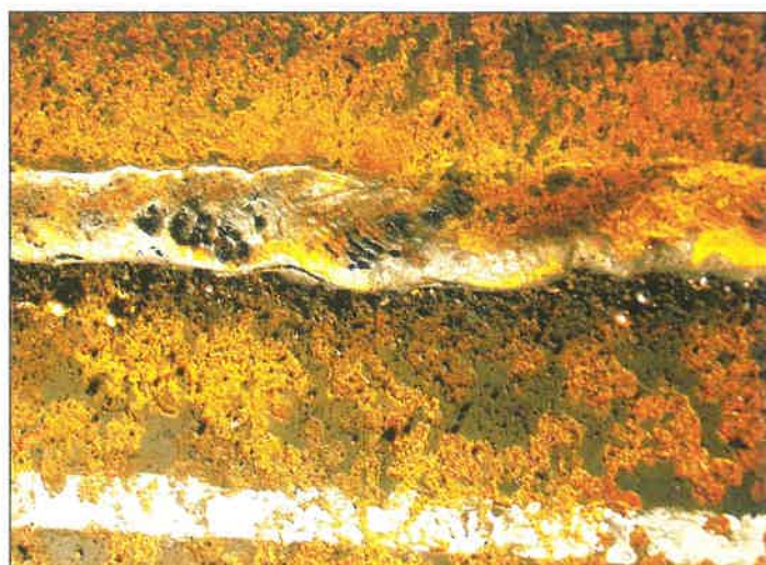
11. felvétel Gőzrobbanás átmenő tömlő-„csóvái” fenékvarratban.
