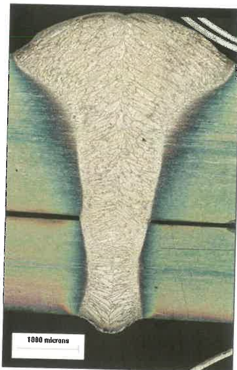
2. ábra. Hibrid lézeres átlapoló hegesztés
