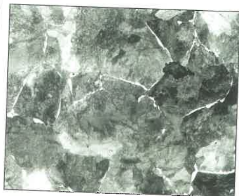
4. ábra Termitvarrat ferritálós perlités szövetszerkezete
