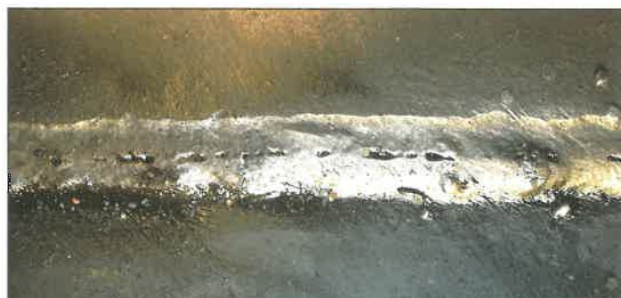
12. felvétel Felületre nyitott átmenő gőz-tömlősor fenékvarratban. (ld. még: a 11. sz. ábrát!)
