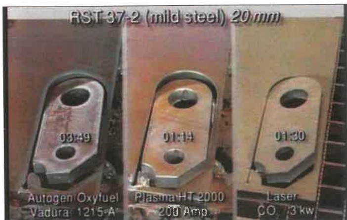
Oxy-acetilén láng-; plazma-; és lézervágással készített darabok felületeinek összehasonlítása)
