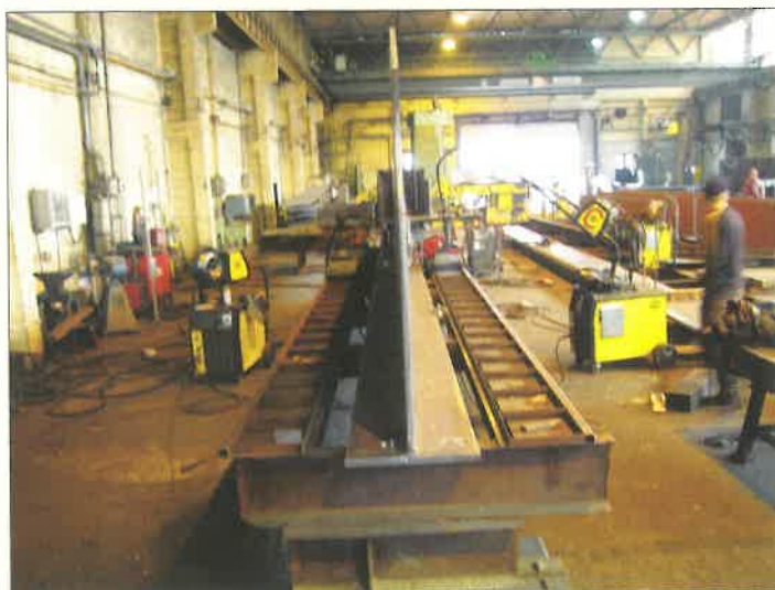
2. ábra. Hossztartók hegesztése két géppel párhuzamosan
