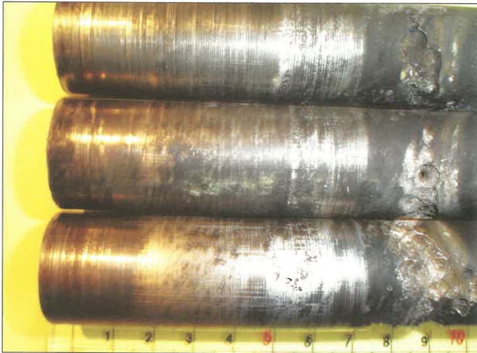
1. ábra A károsodott csövek
