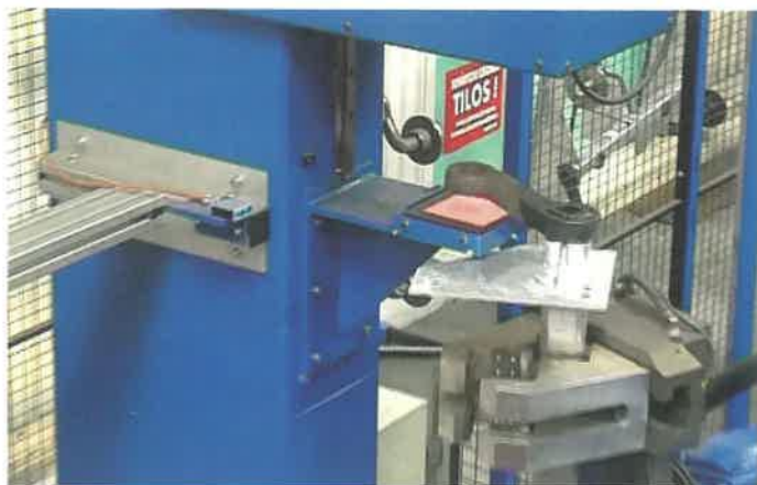
2. ábra: Lézeres és optikai mérőállás (lengőkar furat helyzetkeresés)
