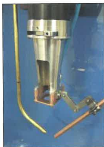
2. ábra. A lézersugaras hegesztőfej képe és sematikus elrendezése
