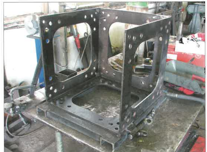
10. ábra. A csatlakozókocka összeállító sablonja
