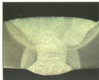
12. ábra: Porbeles huzallal hegesztett gyök kerámia alátétes fürdőbiztosítással és fedettívű takarósorok
