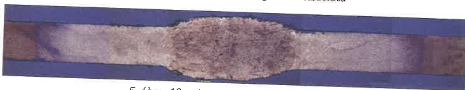
5. ábra. 12. minta metallográfiai csiszolata
