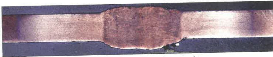
7. ábra. Az 5. minta metallográfiai csiszolata
