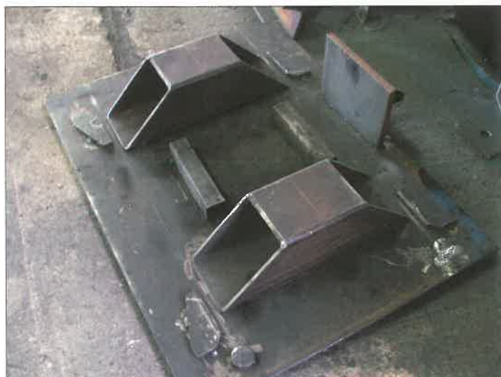
8. ábra. A feszítősodrony fogadó egység összeállító sablonja
