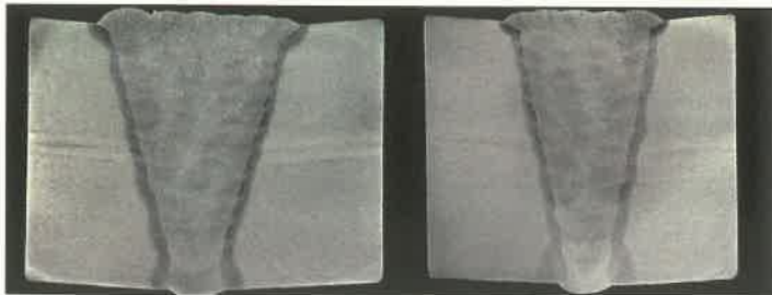
14. ábra: 15°-os és 12°-os leélezés porbeles huzalos, kerámia alátétes hegesztéshez
