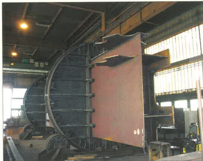
3. ábra. Forgató berendezés a pályaelemek hegesztéséhez
