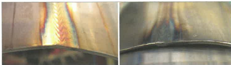
3. ábra. A hosszvarrat befutási oldala egyengetés előtt (balra) és egyengetés után (jobbra)
