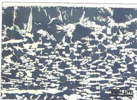
6. ábra. Az eredeti és az optimalizált UR45N acél hőhatásövezetének mikroszerkezete: ferrittartalom (sötétre színeződött fázis) 78%, illetve 68% [13]
