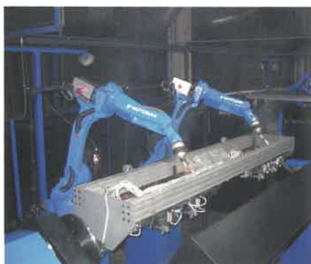
4. ábra. Nagysorozatú gyártás megvalósítása ikerrobotos hegesztőcellában
