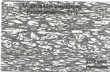
4. ábra. Az UR45N duplex acél mikroszerkezete [13]
