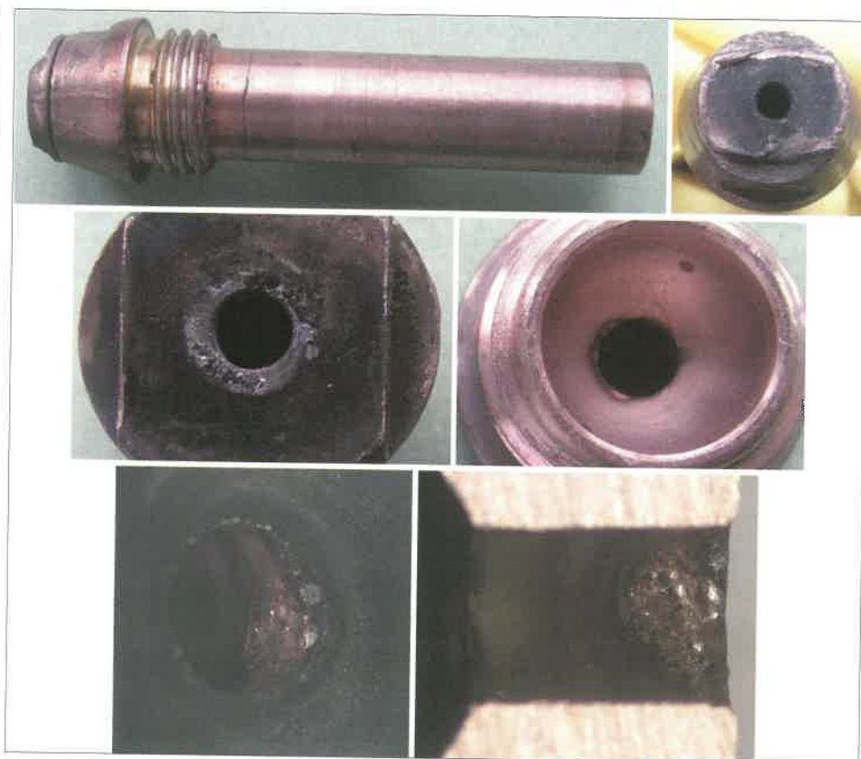
7. ábra. A plazma-hegesztőpisztoly kerámia gázterelője
