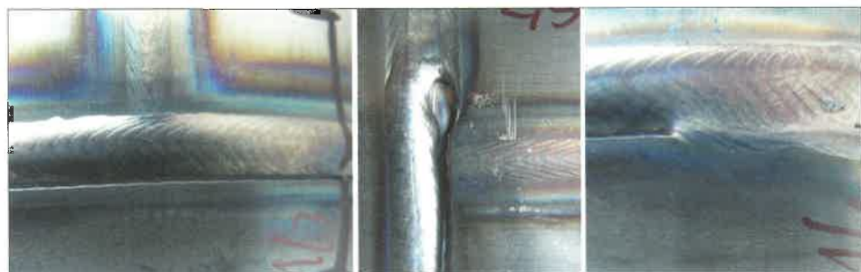
4. ábra. Hibátlan varratatlákozás (balra) és hibás jellegzetes körvarrathibák (középen és jobbra)
