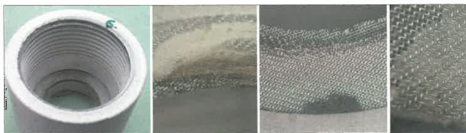
6. ábra. A plazma-hegesztőpisztoly kerámia gázterelője
