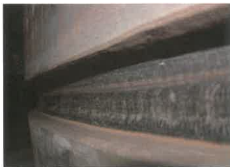
3. és 4. ábra Varrat félautomatikus hegesztéssel
