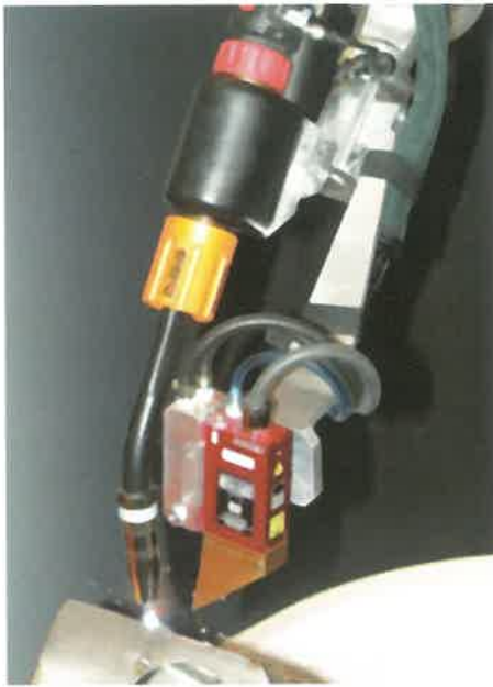
10.kép. CTS 60 típusú online lézerszenzor a robothegeztési folyamat során a varratgeometria követéséhez és méréséhez
