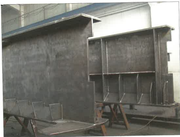
6. ábra. Ostkreuz, Berlin: A főtartók készrehegesztett állapotban
