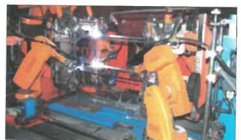
8.kép. Teljesen automatizált ROMAT® hegesztősor kapcsolószekrények poradagolásos plazmahegesztéssel végzett gyártásához
