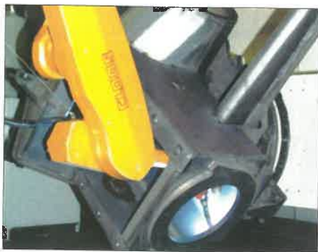
5.kép. Nagytérfogatú építőgépház hegesztésére alkalmas, ésszerűen tervezett MAG-TANDEM hegesztés ROMAT® ipari robottal
