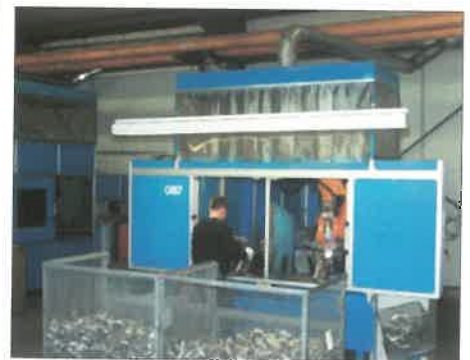
7.kép. Kompakt, kedvező árfekvésű Z-sorozatú, a munkadarab behelyezésére, ill. a hegesztésére elkülönített robothegeztő cellájú általános berendezés általános alkalmazásra
