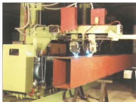
1.kép. Hagyományos, teljesen mechanikus, többgázos kivitelű egyedi hegesztőkészülék a 70-es évek elejéről
