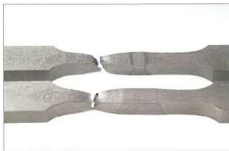
5A. ábra Szakító próbatest, törés az alapanyagban
