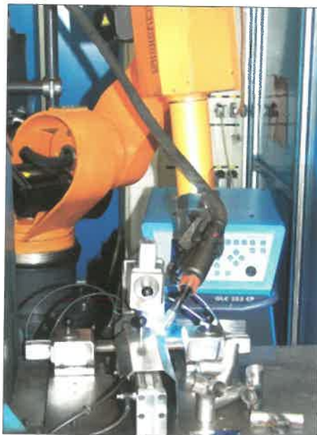
6.kép. ROMAT® 350 típusú ipari robot a CP-eljáráshoz (Cold Process) vékony nemesacél alkatrészek gyártásához autóbészálítók számára
