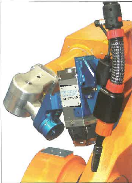
9.kép. Új lézer-hibrid hegesztőfej
