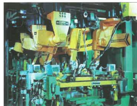
2.kép. 80-as évek: Komplet ROMAT® robothegesztő rendszer gépjárművek mellő tengelytartó elemének hegesztéséhez
