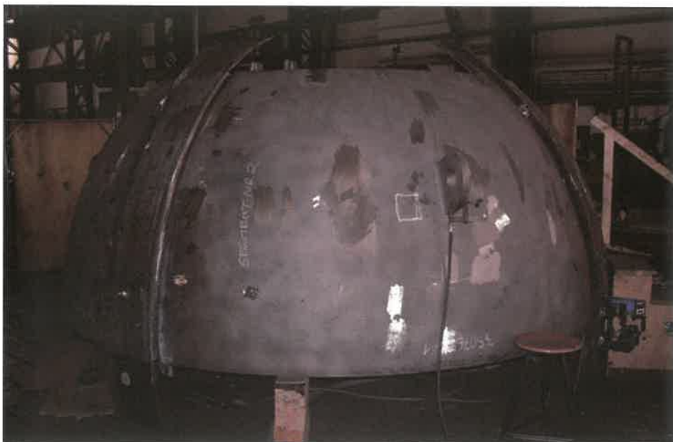
2. ábra. A négy szegmensből összeállított félgömb
