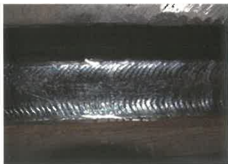
3. és 4. ábra Varrat félautomatikus hegesztéssel
