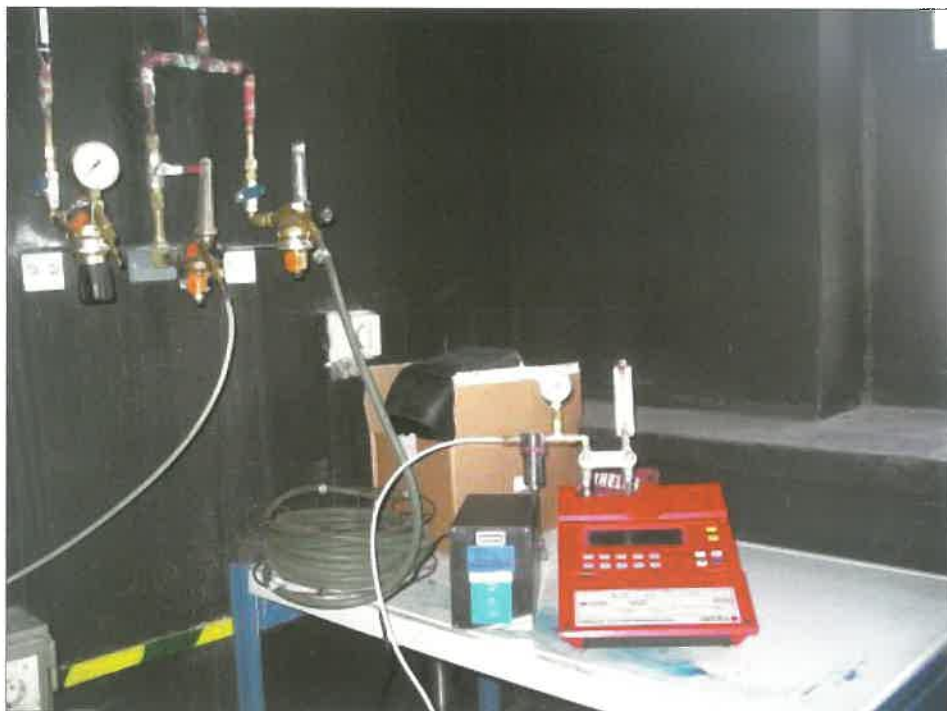
5. ábra. Hegesztési védőgázkeverék összetételének és nedvességtartalmának ellenőrzése egy központi gázellátó rendszer esetén
