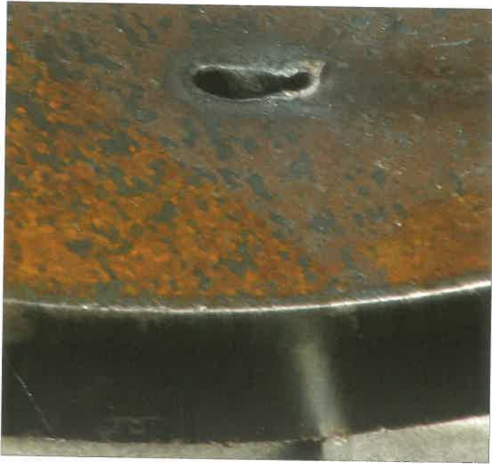
9. ábra. Plazmával való lyukasztás eredménye.
