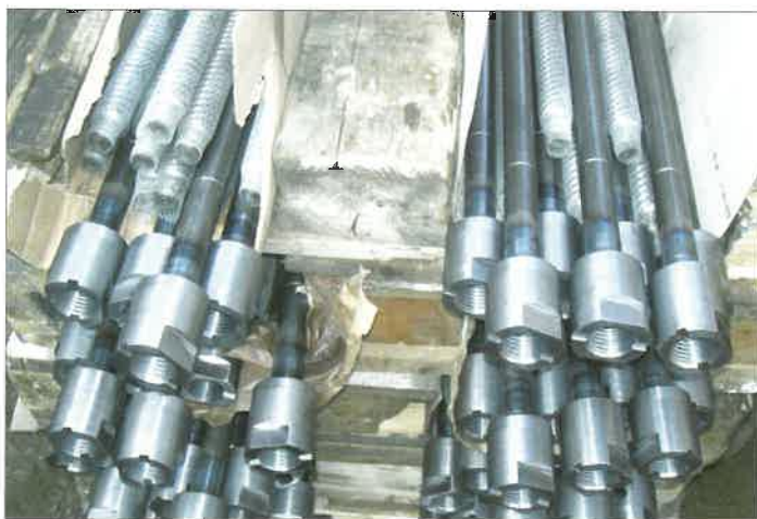
3. ábra. Dörzshegesztett vasúti kocsi fék-állítórúd
