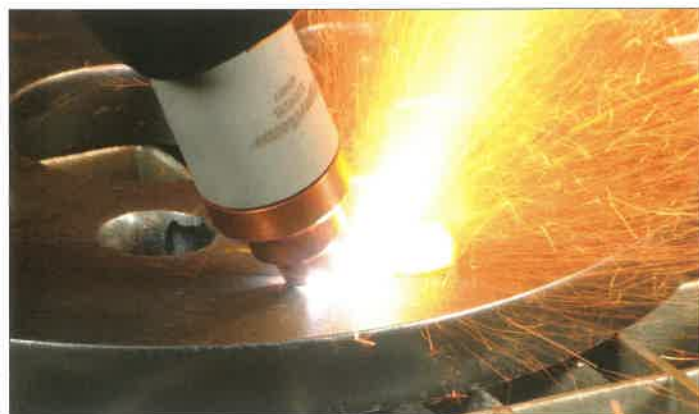
8. ábra. A plazmával való lyukasztás növeli a produktivitást, nincs szükség előmelegítésre
