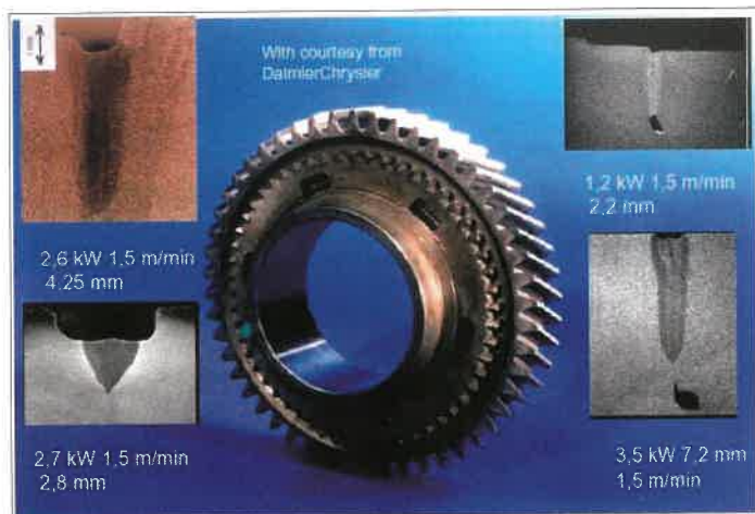
3. ábra. Hajtóműalkatrészek mélyvarratos lézeres hegesztése
