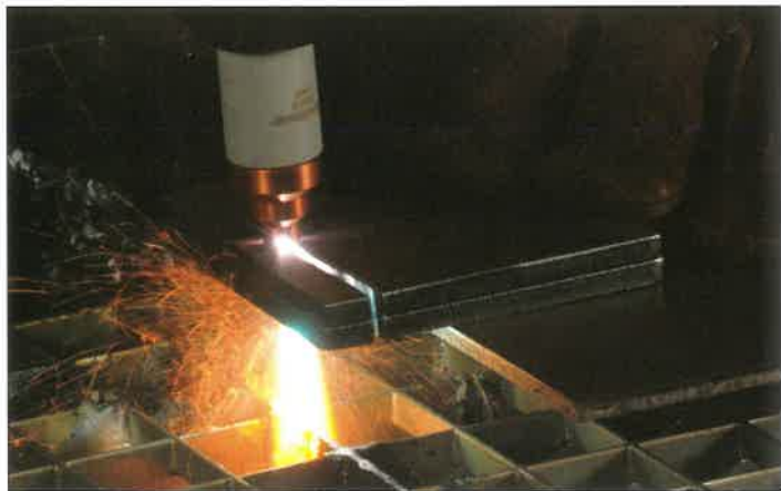
1. ábra. Plazmavágóval több egymásra helyezett lap is vágható egyszerre
