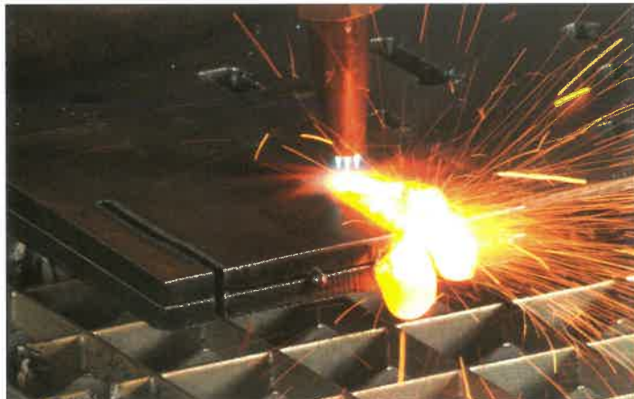
2. ábra. Lángvágóval nem lehet több egymásra helyezett lapot vágni egyszerre
