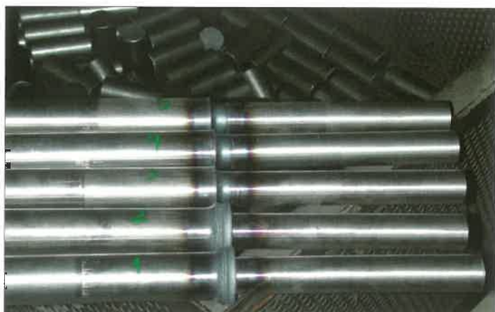
4. ábra. Dörzshegesztett szivattyúmotor tengely (anyag KO 33 + C45), gallérrel, és melegen leesztergált gallérrel
