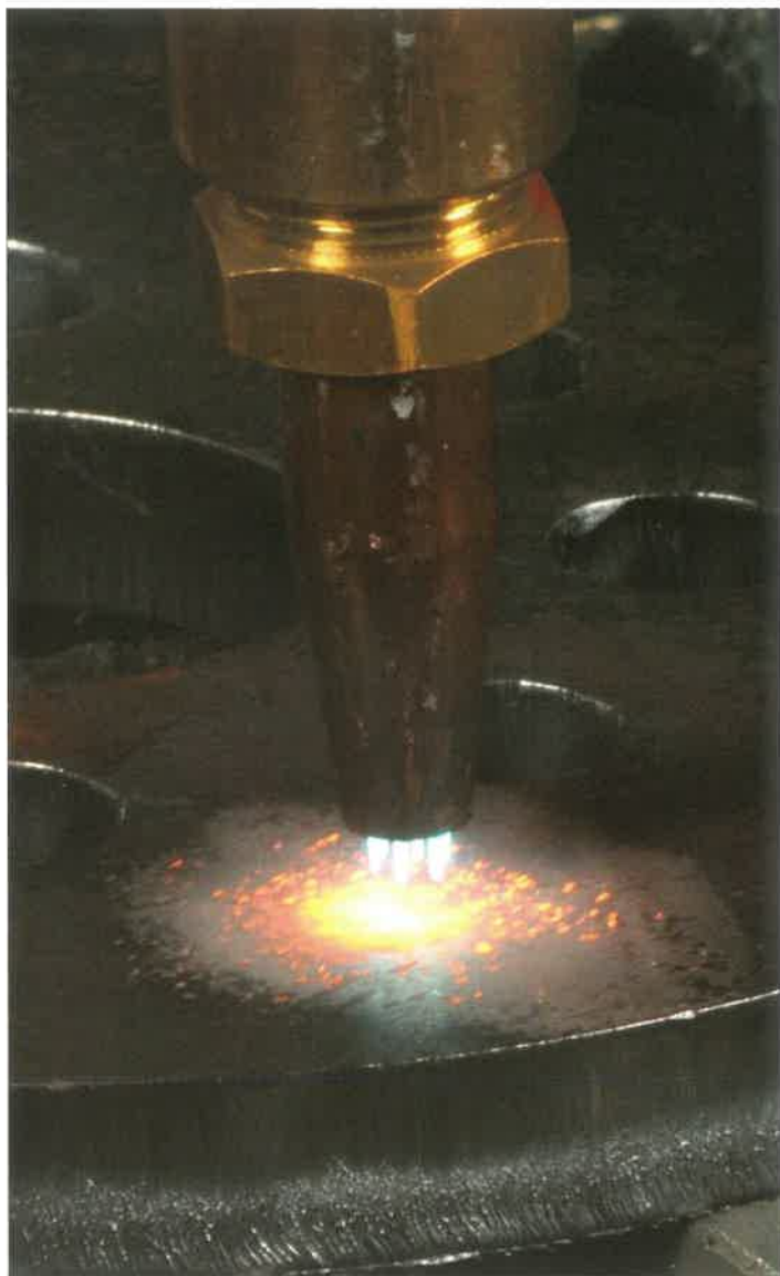
7. ábra. Lángvágás során a fémot csaknem 1000°C-ra kell előmelegíteni a lyukasztás megkezdése előtt
