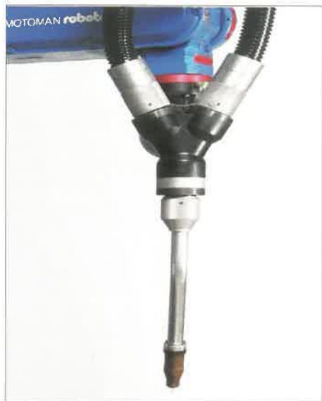
4. ábra. Dual huzalváltó rendszerű hegesztőpisztoly
