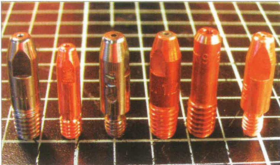
1. ábra. Becsavarható áramátadó hüvelyek védőgázos ívhegesztéshez
