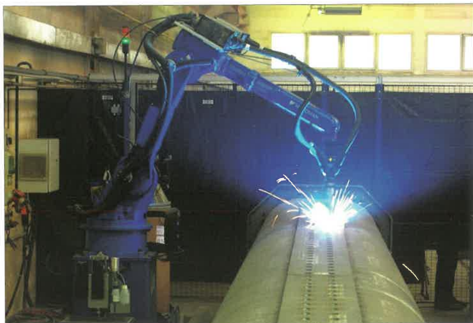
3. ábra. Lamellák hegesztése robottal
