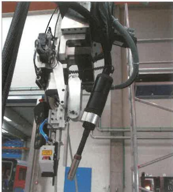
3. ábra. A robotkar a push-pull pisztollyal, a lézeres varratkövetővel /az elszívó csövek nem üzemi helyzetben vannak/.
