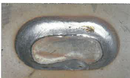
8. ábra. Robottal hegesztett varrat
