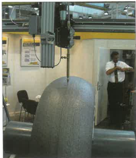
8. ábra KALENBORN felrakó hegesztése és a HYPERTHERM plazmaégője
