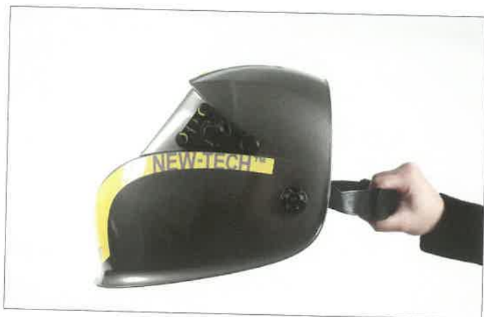
8. ábra. A fejkoszorú merevségének ellenőrzése.
