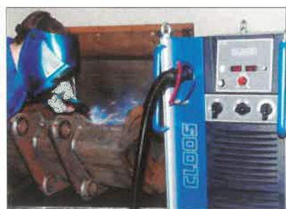
4. ábra. 450A-es fokozatkapcsolós QINEO® STEP készülék vastagfalú építőipari gépelemek nagyteljesítményű hegesztéséhez
