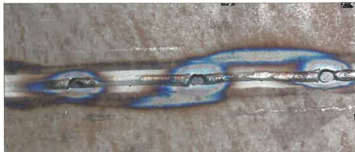
10. ábra. A hőelvonás változása nyomon követhető a kékre színeződött területek kiterjedésének változásán.
