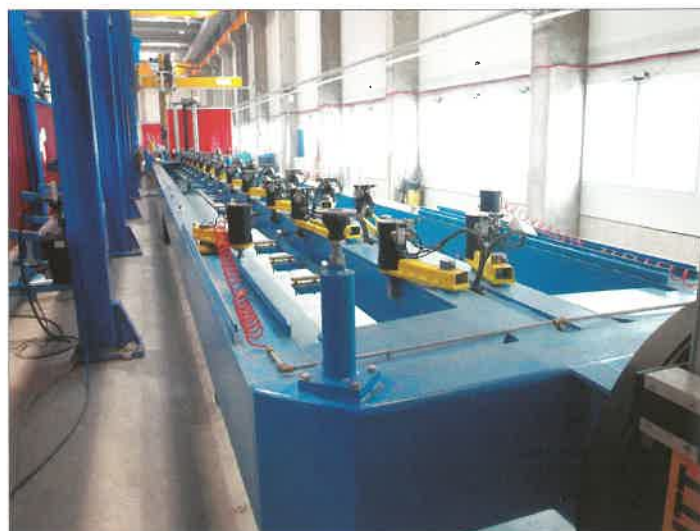
7. ábra. Nagy terhelésekre méretezett szerszámkeret készülékelemekkel
