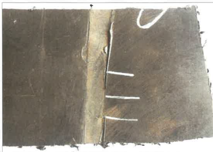
3. ábra. Előkészítetlen felületen felszakadt varratkép
