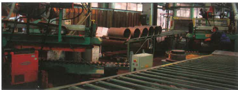
1. ábra. A kétfejes hosszvarrathegesztő berendezés a kép bal, az egyfejes pedig a kép jobb oldalán látható. Középen a hengerített palástok várakoznak hegesztésre
