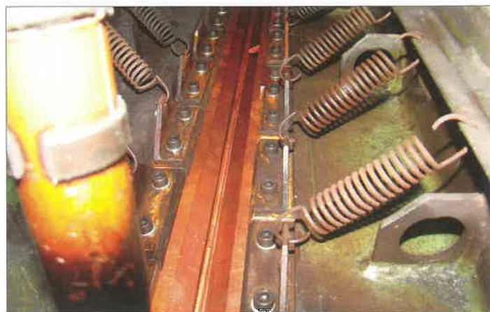
11. ábra. A nem szegmentált kialakítású leszorítópórák a gyökvédő rézsín gyökhornyához képest szimmetrikusan pozicionálva.
