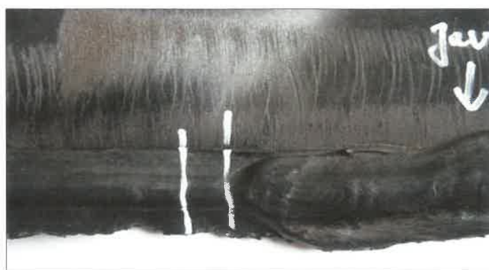
4. ábra. Hibás varrat javítására történt sikertelen próbálkozás
