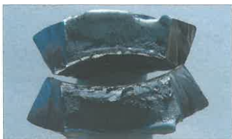
7. ábra. 135-ös eljárás, tömör huzal, PF hegesztési pozíció
