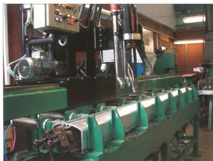
6. ábra. Biztos külső és belső vezetés a vetemedés megakadályozása céljából
