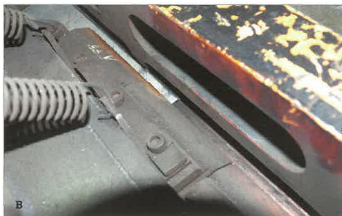
2. ábra. A.) A leszorítópofák nyitott állapotban, közöttük a gyökoldali rézsínnel; B.) A pozicionáló tüske leeresztett állapotban és a palást élé nekiütköztetve
