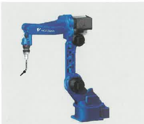
7. ábra: Ívhegesztési célra kifejlesztett robot
