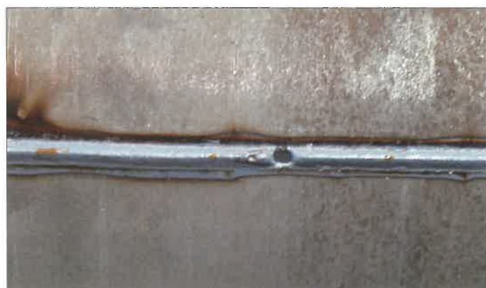
6. ábra. Egy jellemző átégés. Megfigyelhető, hogy sem előtte, sem utána nincs arra utaló jel, hogy bármilyen hiba csúszik a hegesztési folyamatba
