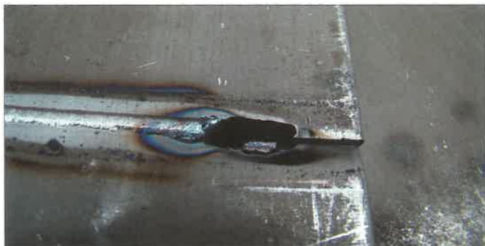
10. ábra. A hőelvonás változása nyomon követhető a kékre színeződött területek kiterjedésének változásán.
