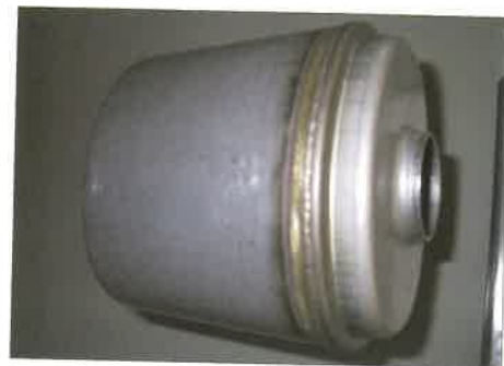
10. ábra. Kipufogórendszer, Tandem forrasztás AlBz 8 hozaganyaggal, hegesztési sebesség 6 m/min
