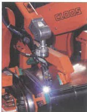
6.a ábra. Alumínium üzemanyagtartályok hagyományos MIG hegesztése lézerszenzorral, hegesztési sebesség 80 cm/min
