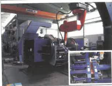
14. ábra. Üzemanyagtartályok plazmahegesztése az autóipar számára
