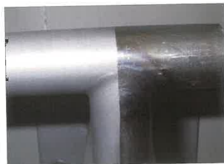
16. ábra. PPAW hegesztés a bútoriparban. Baloldal festve, porfelvételi sebesség: 25g/min
