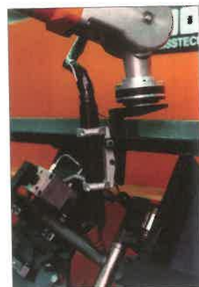
17. ábra. Kerékpárvázak PPAW hegesztése
