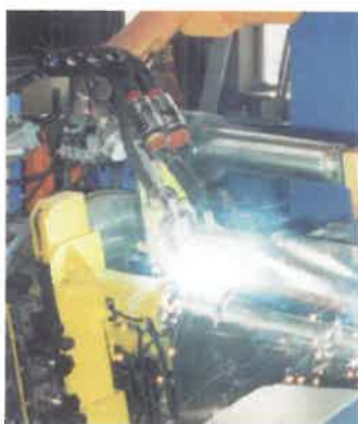
6.b ábra. Azonos hegesztési feladat, mint 6.a ábrán, itt: tandem hegesztés, hegesztési sebesség: 180 cm/min
