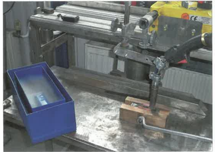
8. ábra. Kísérleti összeállítás a hegesztett varratok elkészítésére és azt követő lehűtésére.
