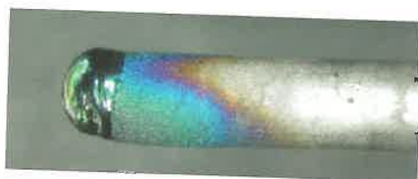
18. ábra Oxidálódott elektródacsúcs
