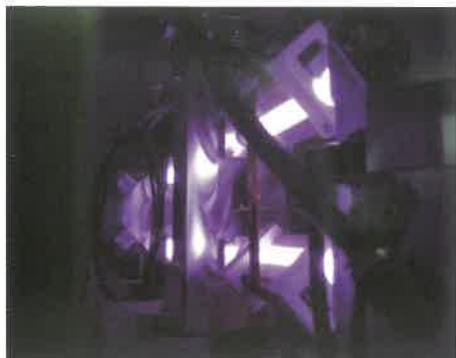
18. ábra. Szén-dioxid lézer rezonátor munka közben
