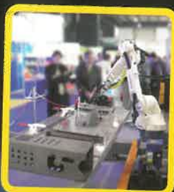
A MUNKADARAB SZÉLEK VÁGÁSA ÉS ELŐKÉSZÍTÉSE ROBOTTAL
