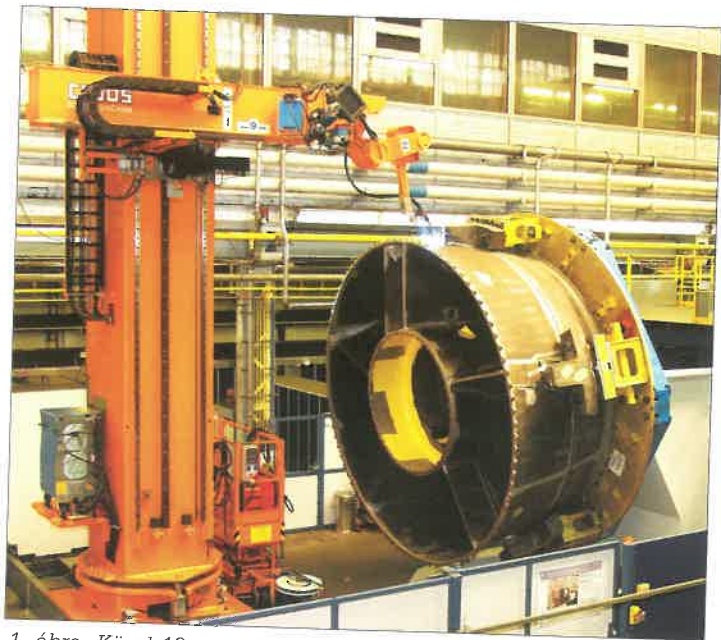
1. ábra. Közel 10 m magas C-oszlopra erősítve dolgozik a robot; a hegesztési időt a kézi hegesztéshez képest 35 órával csökkentve.
