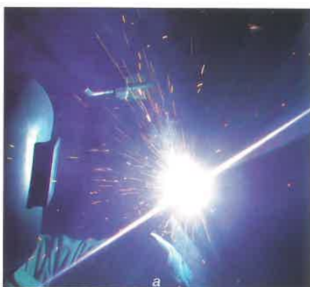
6. ábra. Két-, (a), ill. háromkomponensű (b) gázzal történő hegesztés (a fotók a háromkomponensű védőgáz első bevezetésének időszakában készültek)
