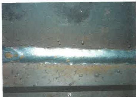
4. ábra. 82/18-as kétkomponensű gázzal készített varrat (erős fröcskölés, egyenetlen szegély), és annak beolvadási profilja
