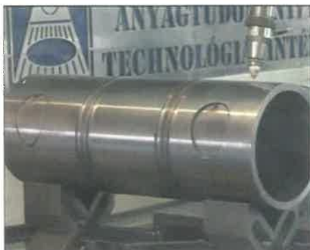
9. ábra. Vastagfalú rozsdamentes cső vágása
