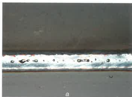
5. ábra. Háromkomponensű gázzal (90/8/2 – Ar/CO 2 /O 2 ) készített varrat (fröcskölés-mentes, egyenletes szegély, kisebb felületi salakfoltokkal), és annak beolvadási profilja
