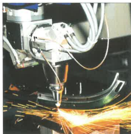
7. ábra. Lézersugaras 3D vágás
