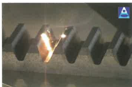
11. ábra. Fogasléc lézersugaras edzése
