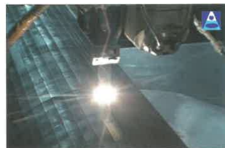
12. ábra. Bordafelület lézersugaras edzése
