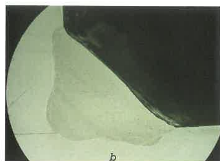
5. ábra. Háromkomponensű gázzal (90/8/2 – Ar/CO 2 /O 2 ) készített varrat (fröcskölés-mentes, egyenletes szegély, kisebb felületi salakfoltokkal), és annak beolvadási profilja
