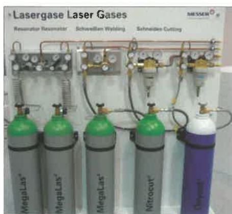
19. ábra. Lézer rezonátorgázok és munkagázok lefejtői
