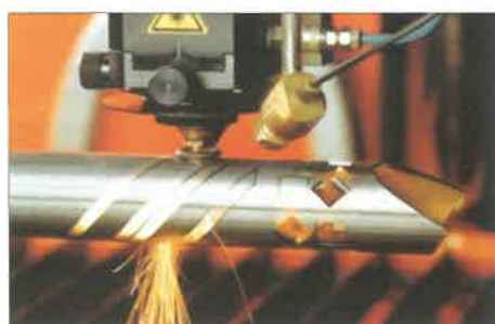
6. ábra. Lézersugaras csővágás
