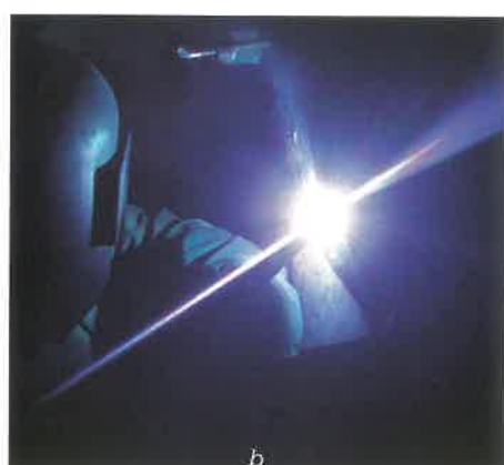
6. ábra. Két-, (a), ill. háromkomponensű (b) gázzal történő hegesztés (a fotók a háromkomponensű védőgáz első bevezetésének időszakában készültek)
