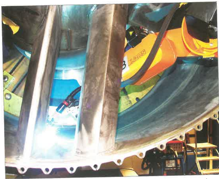
3. ábra. A Siemens cég CAD-szerkezeti elem adatbázisa alapján végezte el a CLOOS a robot off-line programozását.
