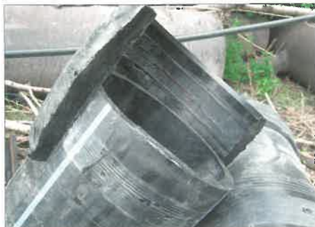
3. ábra. Hántolás nélkül hegesztett kötés nyomáspróba után
