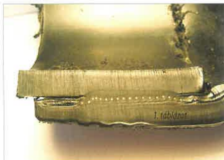
2. ábra. Elektrofúziós csőkötés metszete: tökéletes hézagzárás
