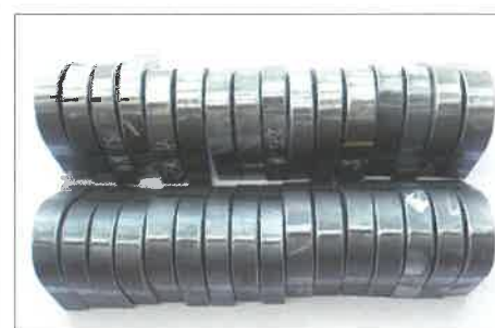
7. kép. Keresztirányú hajlítóvizsgálatok próbatestei a vizsgálat után
