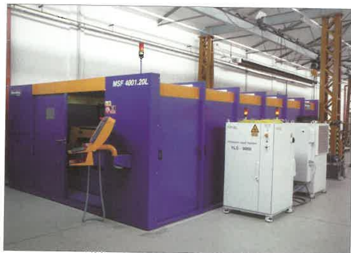
18. ábra. MicroStep 4001.20L fiber lézer sugárforrással és hűtővel
