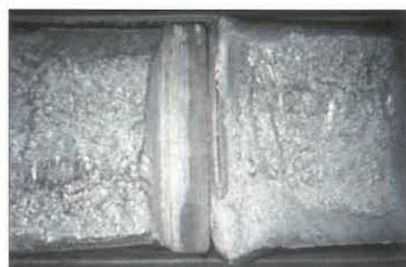
8. kép. Az ütdmunka-vizsgálatok próbatestei
