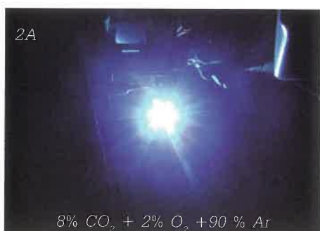
2, 3. kép. A különböző védőgázok hatása a varrat külalakjára, valamint a hegesztési folyamatra
