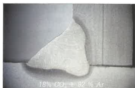
2, 3. kép. A különböző védőgázok hatása a varrat külalakjára, valamint a hegesztési folyamatra
