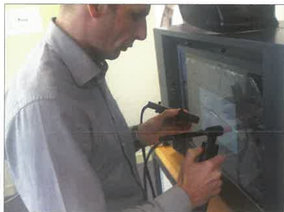
4. ábra. Az AVI-eljárás mozgáskoordinációját oktató virtuális alkalmazás
