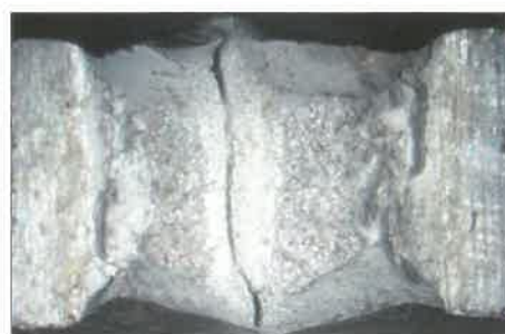
8. kép. Az ütdmunka-vizsgálatok próbatestei
