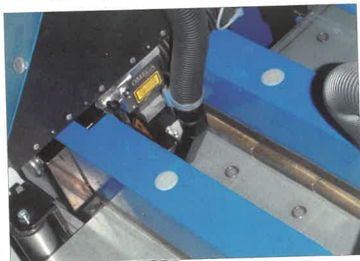
11. ábra. Omega típusú lézersugaras hegesztőfej és a hegesztések
