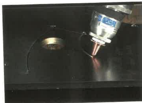
9. ábra Ferde vágás lézersugárral
