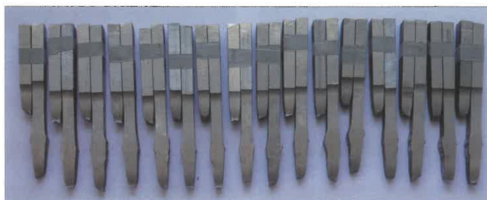
6. kép. A keresztirányú szakítóvizsgálatok próbatestei a vizsgálat után
