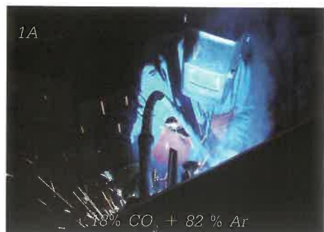
2, 3. kép. A különböző védőgázok hatása a varrat külalakjára, valamint a hegesztési folyamatra
