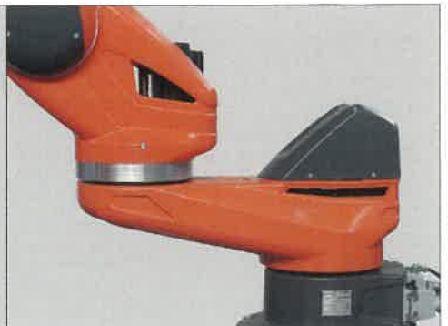
4. kép: Az opcionális excentrikus tengelyt ráépítették a robotlábba (7. robot tengely), így a munkatartomány jelentősen megnövekedett.
