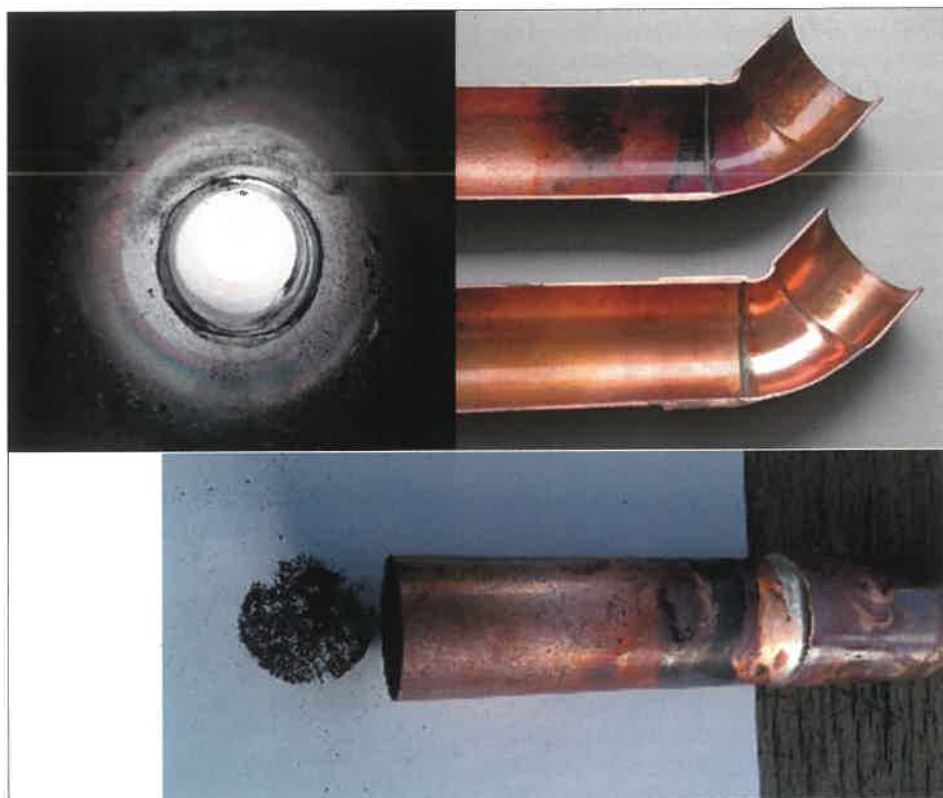
16. ábra. Rézcsövek forrasztása során keletkezett szennyeződések
