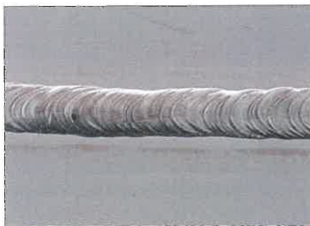
1. ábra. Gyökoldali varratsor gyökvédelemmel (jobb kép) és a nélkül (bal kép) saválló acél AVI hegesztése.
