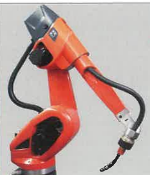
3. kép: Új QIROX® csőtengelyes robottípus QRH belső kábel-szerelvény, és Cloos közbelső bokszt.
