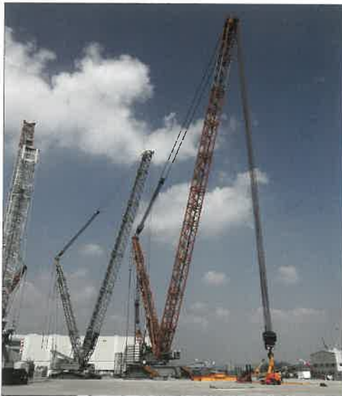
A világ legnagyobb lánc talpas darujának csupán a futóműve 3,5 m magas, ami két egymáson álló ember magasságával ér fel.
