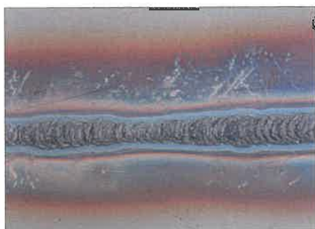
1. ábra. Gyökoldali varratsor gyökvédelemmel (jobb kép) és a nélkül (bal kép) saválló acél AVI hegesztése.
