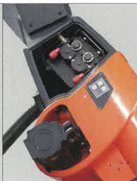
2. kép: Kompakt és kényelmes: az újonnan kifejlesztett közbelső bokszt beépített huzalelőtolóval.
