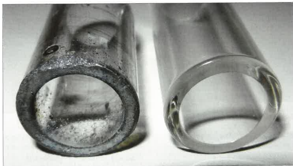
11. ábra. Pyrex gázterelő kilépő vége egy műszakos használat után és új állapotban
