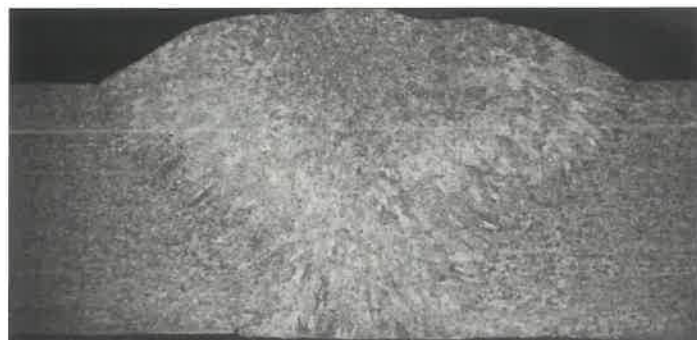
2. ábra. Az AFI hegesztéssel készült kötés makrocsiszolati képe
