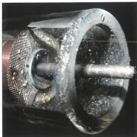
9. ábra. Pyrex gázterelő kilépő vége négy óra használat után
