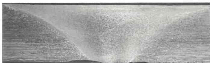
3. ábra. FSW hegesztéssel készült kötés makrocsiszolati képe
