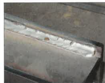
Az erősen fókuszált villamos ív garantálja a biztos gyök kialakítását.
