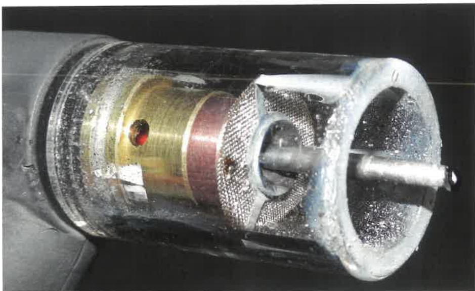
10. ábra. Mindkét végével használt Pyrex gázterelő
