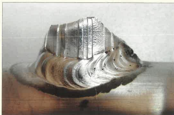
10. ábra Kötésszakítás utáni fél próbadarab
