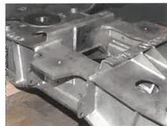
A korszerű vasúti forgóvázak – melyek súlya 800 és 1000 kg között lehet – hegesztésénél 60÷150 folyóméter hosszúságú varrat fordul elő.
