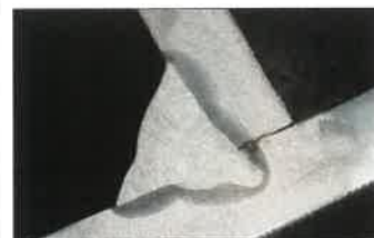
A Rapid Weld nagyteljesítményű hegesztési eljárás: optimális beolvadási mélység, tökéletes a gyök, mint az itt, egy sarokvarratnál látható.
