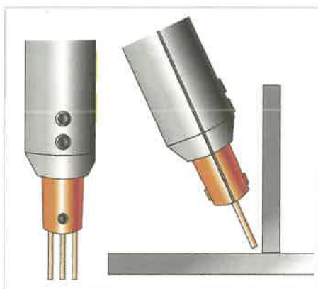
9. ábra. ICE™ DC+ hegesztőfej 3x2,5 mm átmérőjű huzallal
