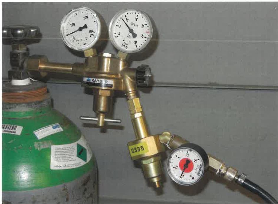
14. ábra. GS35 gázfelhasználást csökkentő és tömlő gáz nyomásmérő a palack reduktoron
