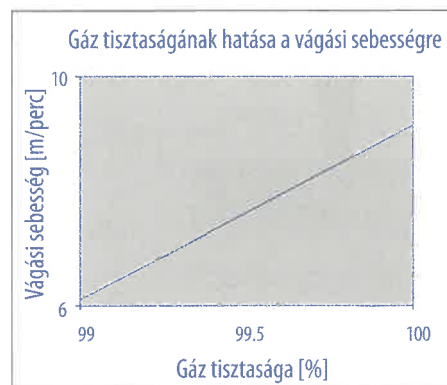
8. ábra. Gáz tisztaságának hatása a vágósebességre gázlézerek esetén. [7]
