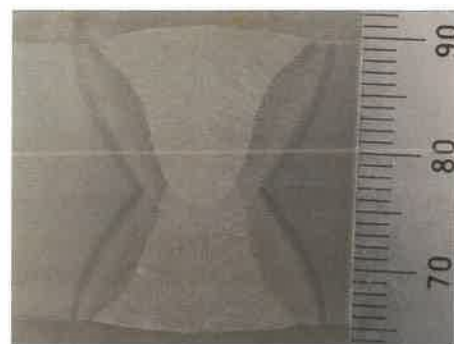
10. ábra. 25 mm vastag S355 NL (EN 10025-3) anyagminőségű szimmetrikus X varrat minimális varratdomborulattal
