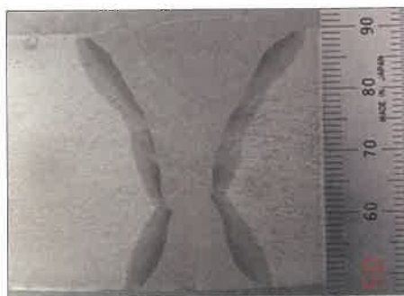
2. ábra. 40 mm vastag aszimmetrikus X varrat S355 NL (EN 10025-3) anyagminőség, hat sorból kialakítva
