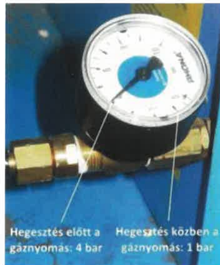
2. ábra AVI hegesztőgép gáztömlőjébe szerelt nyomásmérő
