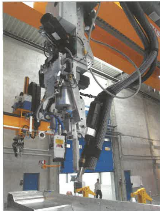
2. ábra. Bonyolultabb, 3+6 szabadságfokú hegesztő célgép varrathely-követéssel, elszívással
