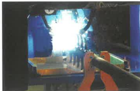
3. kép. Két hegesztőpisztoly hegeszti az uszonybordát az alátámasztó csőre.
