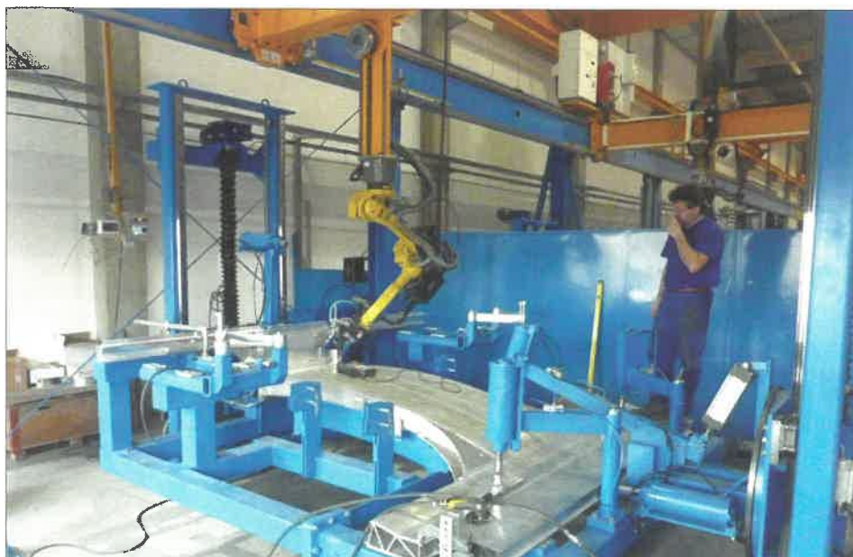
6. ábra. Robotos hegesztő cella hegesztő készüléke emelő-forgatóban
