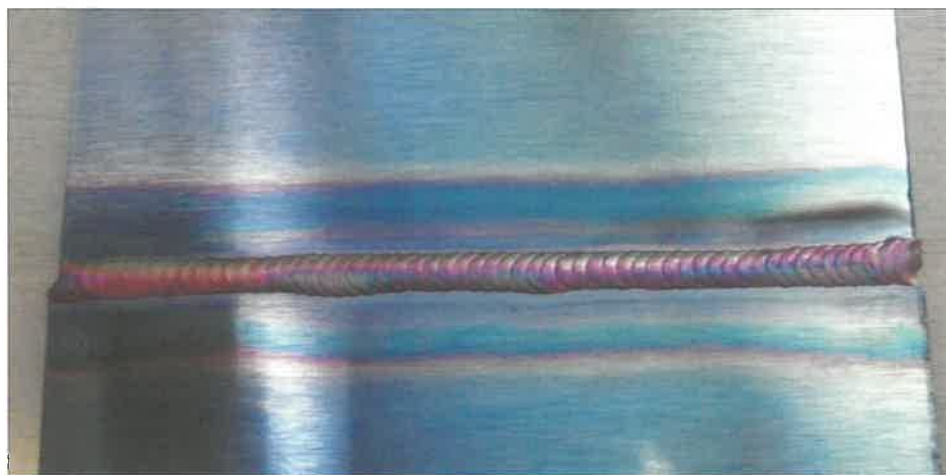
4. ábra. Folyamatos (a) és szakaszos (b) huzaladagolással készült varrat
