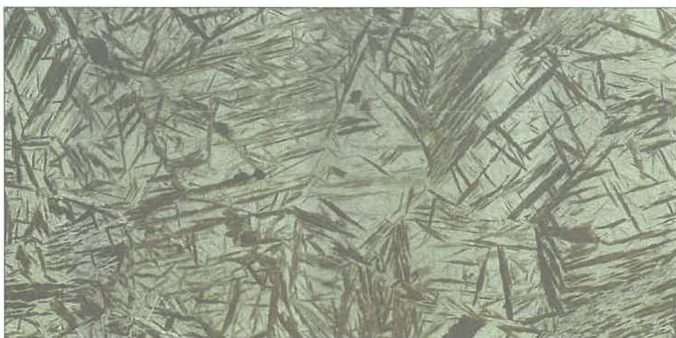
2. ábra. A hőhatásövezet martenzit-bénites szövetszerkezete
