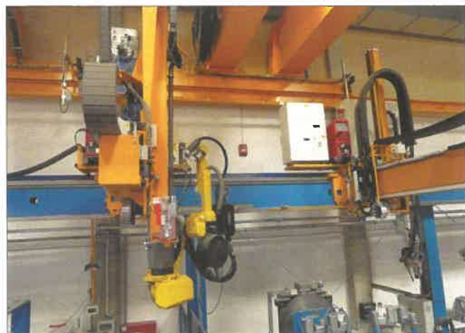
3. ábra. 11 szabadságfokú robot és 9 szabadságfokú célgép felsőpályán
