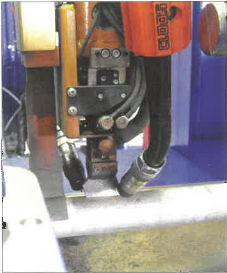
2. kép. Az ésszerűen kialakított, szemben elhelyezett, ellentétes irányban mozgó két hegesztőpisztoly.
