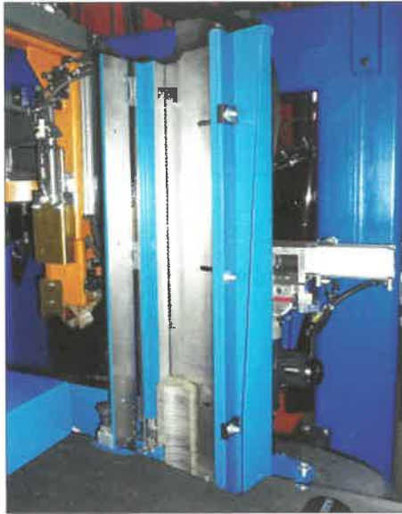
4. kép. Az adagoló különböző típusú uszonybordát képes befogadni, így nagyfokú rugalmasságot biztosít.
