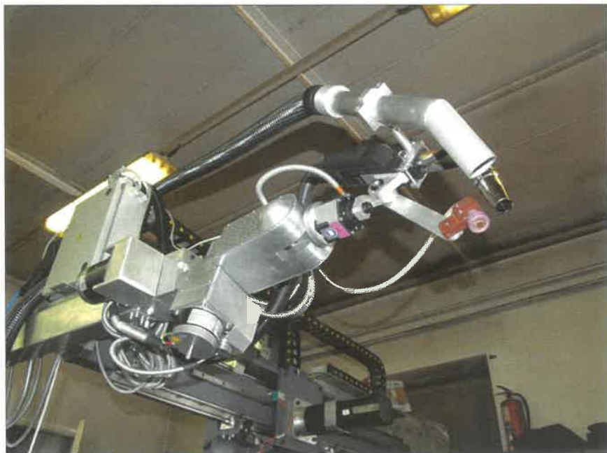
1. ábra. Egyszerű, 3+2 szabadságfokú hegesztő célgép varrathely-követéssel, elszívással
