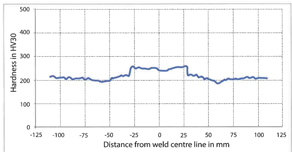
7. ábra. Keménységeloszlás a darusínben termit hegesztés esetén
