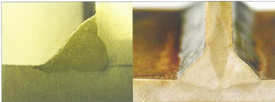
1. ábra. Első beszállító: a kritikus alsó varrat szegélyénél nagy lekerekítést javasol (jobb oldali ábra). A második beszállító ugyanarra a feladatra egy tipikus hegesztést adott meg a varratszegélyénél 0,5 mm-es lekerekítéssel (bal oldali ábra).
