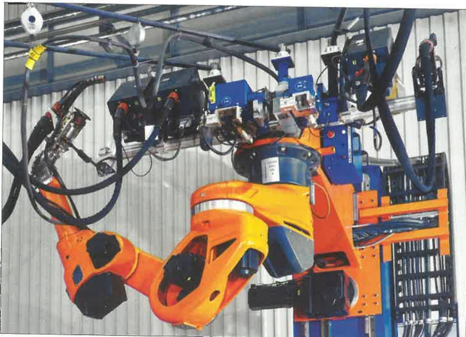
A QIROX robot automatikusan vált az egyhuzalos és a tandemfej között a hegesztési sebességnek megfelelően. A robot fölött látható az automata pisztolytisztító állomás. (Kép: CLOOS)
