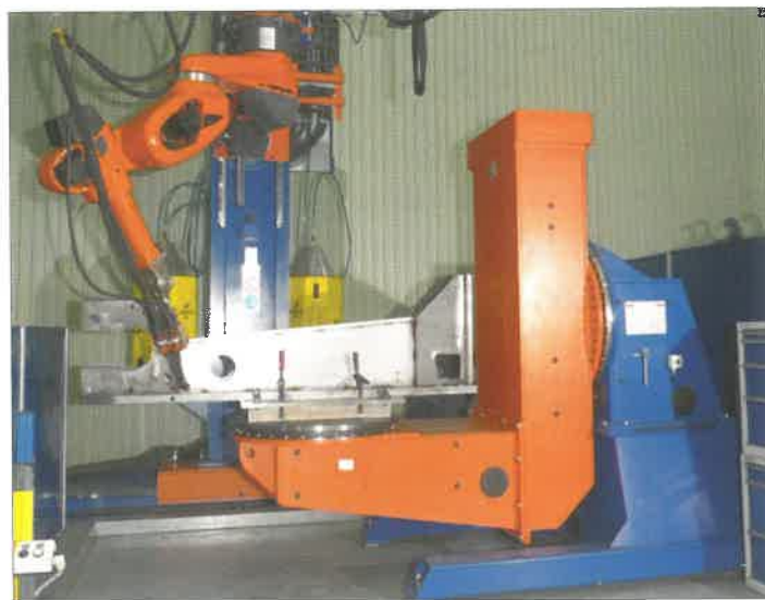
Erre a forgatóra 3 tonnás súlyig szerelhetőek fel munkadarabok – itt a lift egyik eleme – hegesztéshez, mielőtt a nagy forgatóra új munkadarabot helyeznek fel. (Kép: CLOOS)
