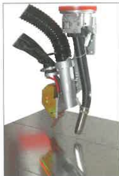
3. ábra. iCAM lézercamera az online varratkövetéshez
