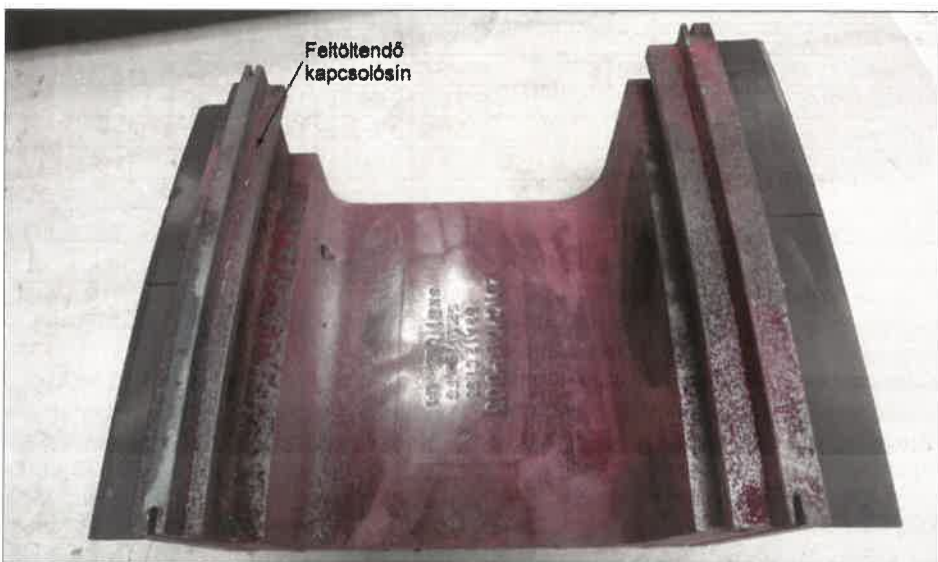
6. ábra. Diafragma beérkezési állapotban
