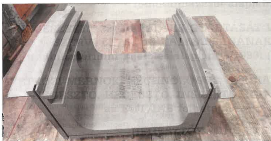
7. ábra. Diafragma homokszórt állapotban
