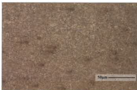
9. ábra. A finomszemcsés övezet mikroszerkezete 5 és 15 s hűlési idő esetén ( T_{max} = 950\text{ °C} , N = 500\times , 2% Nital)
