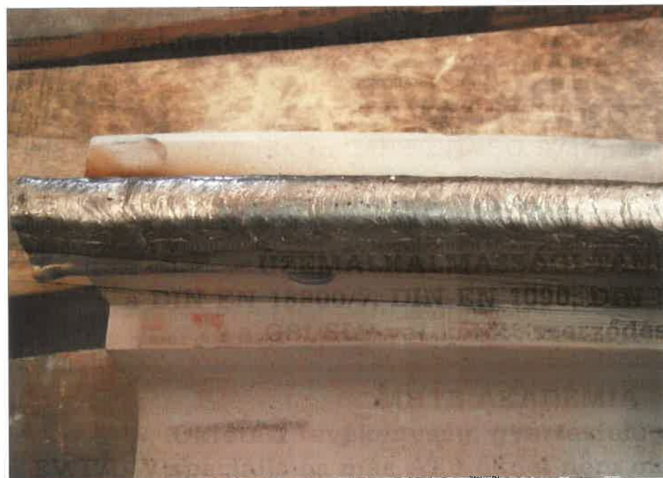
8. ábra. Elkészült varrat
