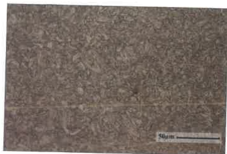
2. ábra. A kísérletekhez használt WELDOX 960 nagyszilárdságú alapanyag nem-egyensúlyi mikroszerkezete ( N = 500\times , 2% Nital)
