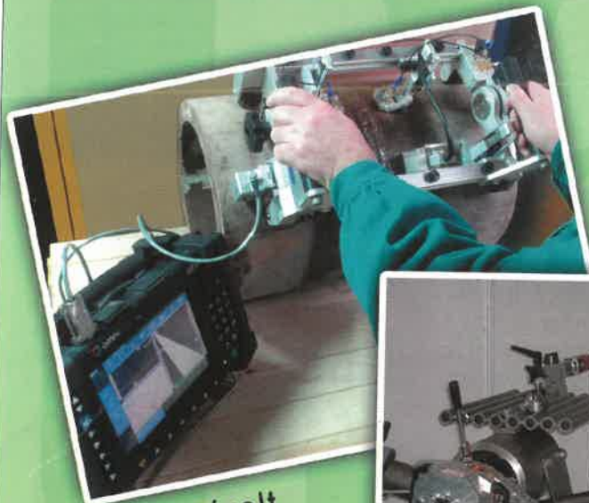
Fázis-vezérelt ultrahangos vizsgálat
