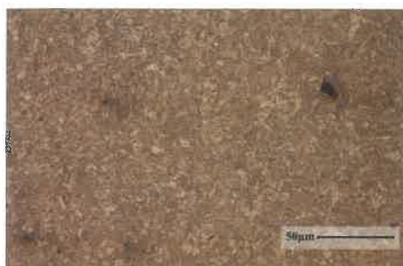
9. ábra. A finomszemcsés övezet mikroszerkezete 5 és 15 s hűlési idő esetén ( T_{max} = 950\text{ °C} , N = 500\times , 2% Nital)
