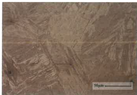
7. ábra. A durvaszemcsés övezet mikroszerkezete 5 és 15 s hűlési idő esetén ( T_{max} = 1350\text{ °C} , N = 500\times , 2% Nital)
