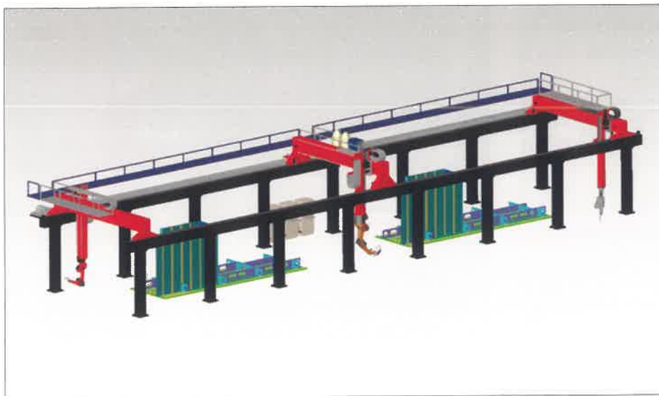
5. ábra. 3D-s layout a bemutató robotberendezésről, ami a QuInLas-szal egy közös projektben készült. A három portálkapu egy gyártás előtti minőségellenőrző lézerfej (jobbra), egy lézer-hibrid hegesztőfej integrált folyamatvizsgálóval (középen) és egy gyártás utáni lézer-szkennerrel és ultrahangos vizsgálóberendezéssel (balra)
