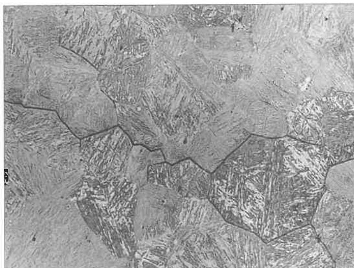
3. ábra. A hűlési sebesség hatása a szemcseméretre és a repedések keletkezésére a beolvadási vonal közelében
