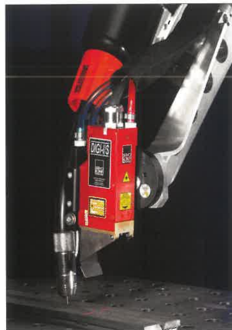
2. ábra. Az előfutó lézerszenzor követi és méri a hézagot, hogy a hegesztési paramétereket folyamatosan a változásokhoz igazítsa
