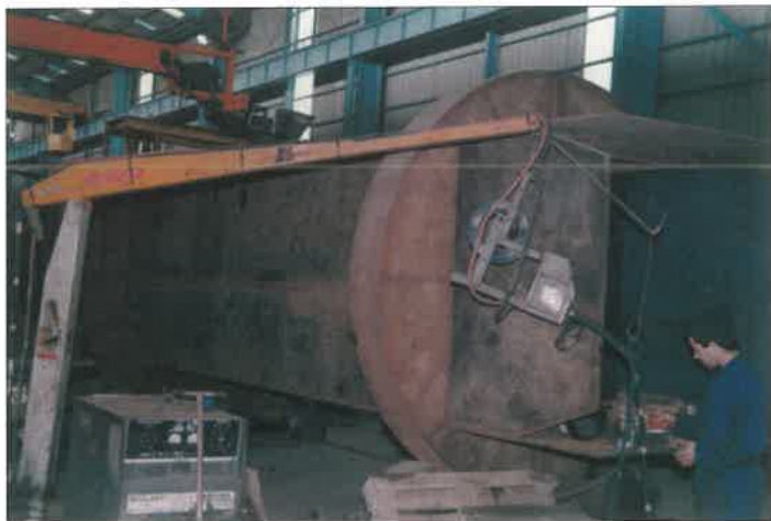
2. kép. Az egyik 6 tonnás daru tornyának a hegesztése.
