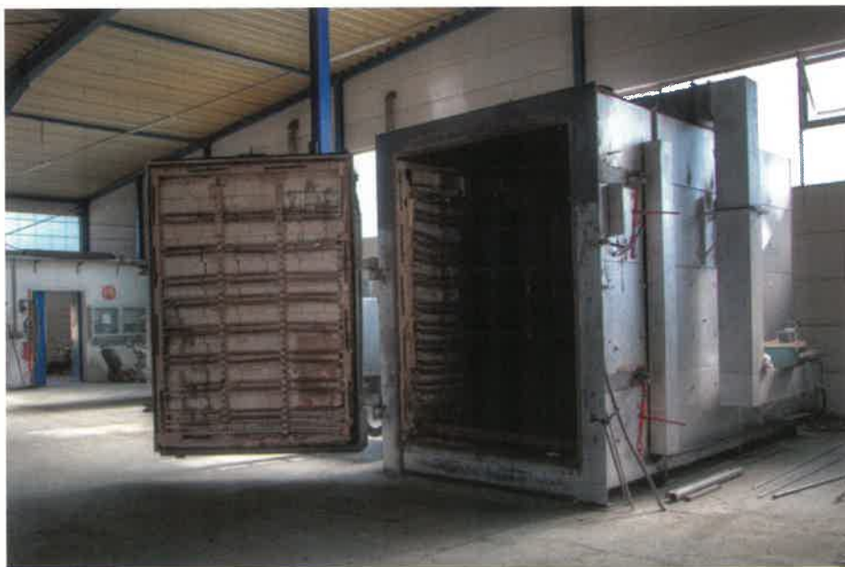
1. ábra. Helyhez kötött hőkezelő eszköz – a kemence (Fa. Bergmann GmbH)
