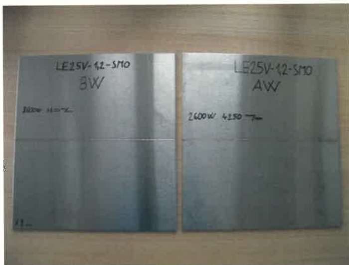
18. ábra: Hosszvarratok hegesztése
