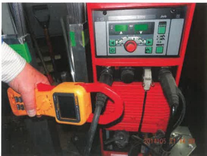
10. ábra AC TIG hegesztő áram mérés lakatfogóval
