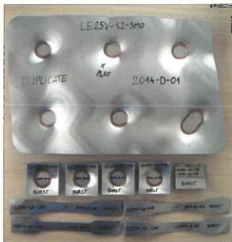
20. ábra: A próbatáblából kimunkált próbatestek
