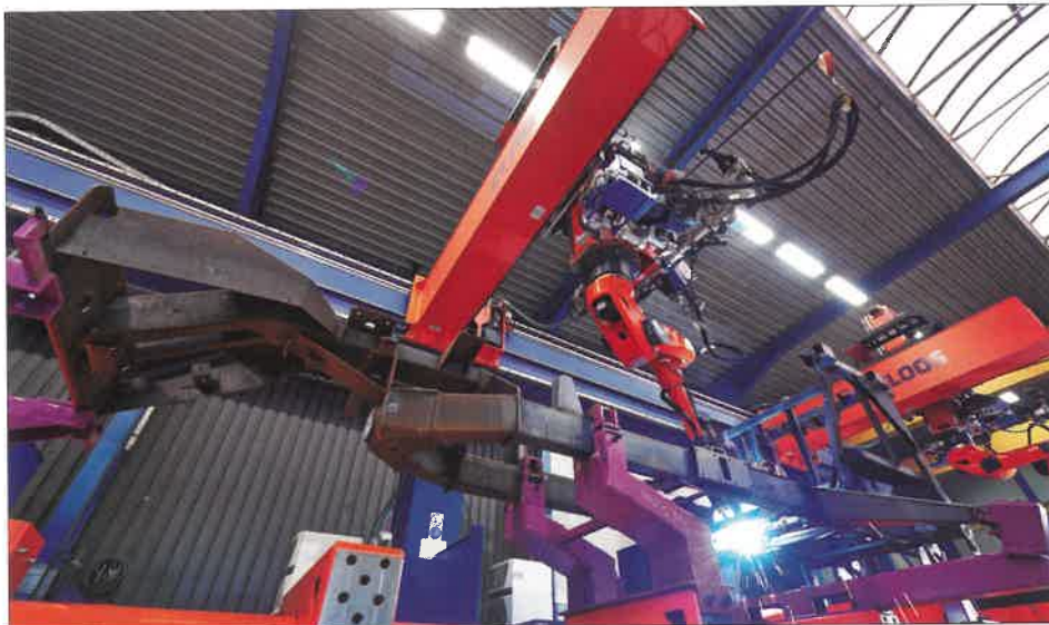
Az önforduló karosszériák, összetett alvázak hegesztését a robotok végézik
