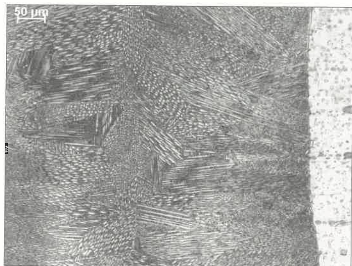
26. ábra: A 2. számú varrat mikroszkópi felvétele – varratfém N = 200x
