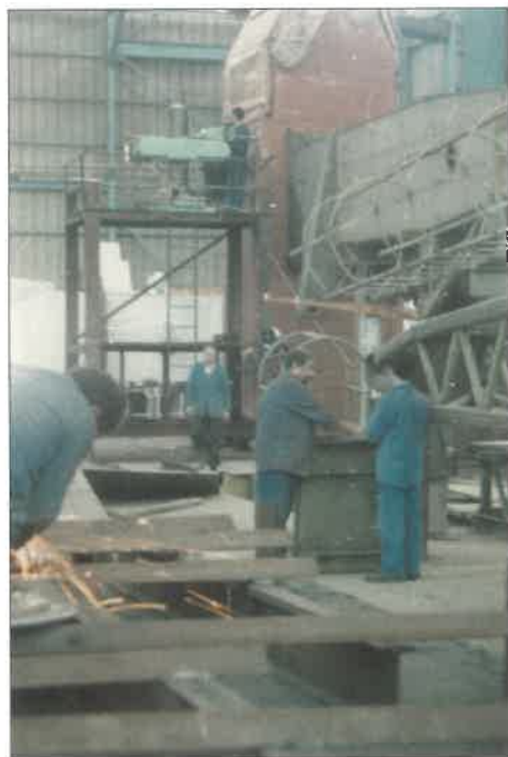
3. kép. Előtérben folyó alkatrészgyártás és a háttérben a kabin és a torony összeállítása.
