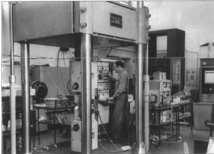
20. ábra. A 150 CT próbatestek vizsgálata a Skoda Pilseni laboratóriumában, 250 tonnás szakítógépen (a gép jobboldalán lévő állványokon a VASKUT és a KFKI műszerei láthatók)
