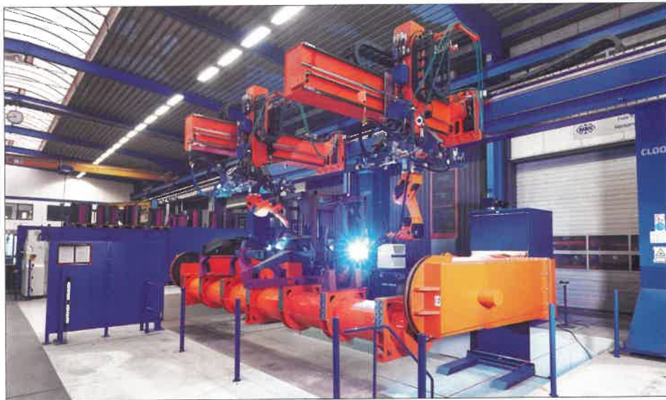
A két egymástól független robotkar egy- és két állomásos üzemmódban is dolgozhat, így különböző alkatrészek is készülhetnek
