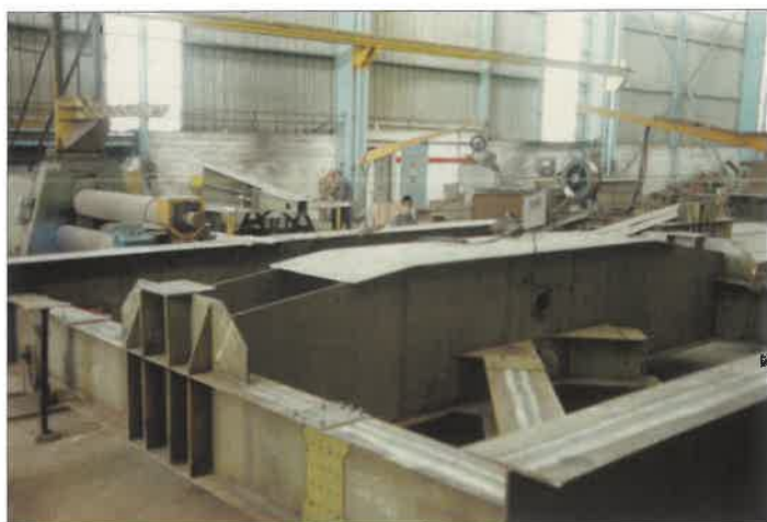
8. ábra. A 10 tonnás állvány teteje és az átlapoló csavaros kötések
