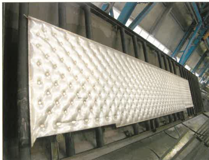
8. ábra: Lamella vízsugaras vágás után
