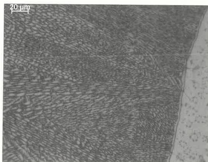
27. ábra: A 2. számú varrat mikroszkópi felvétele – varratfém és HAZ N = 500x
