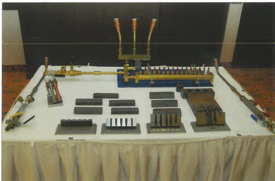
7. kép. Az „éghető gázos” kísérletek eszközei, és próbatestjei
