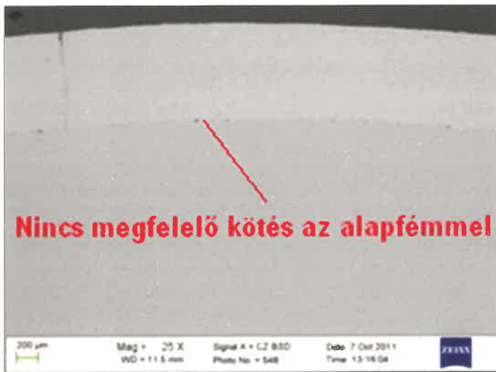
8. ábra Nem megfelelő (túl kicsi) hőbevitel alkalmazása a lézersugaras újraolvasztás során
