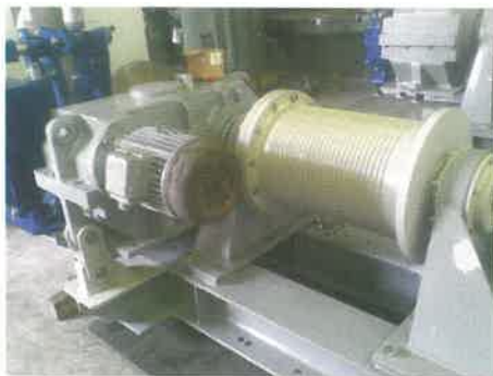
17. ábra. Feltűzött hajtómű fékes motorral (5 tonnás)
