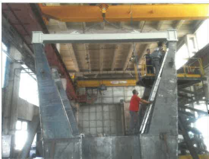
19. ábra. Portálláb-talpak egysíkúságának beállítása
