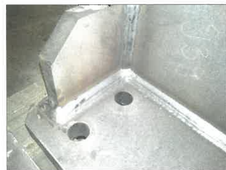
6. kép FOCUS.PULS Ferroline C12X2 (86% Ar + 12%CO 2 + 2% O 2 ) gázzal
