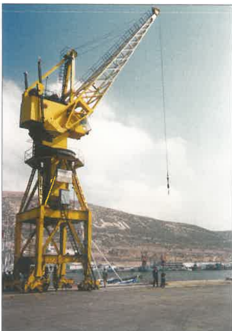
7.1. ábra. Forgóoszlopos, fogasléc billentésű, mérleggémés daru. Agadiri kikötő. A szerző fotója 1988-ból
