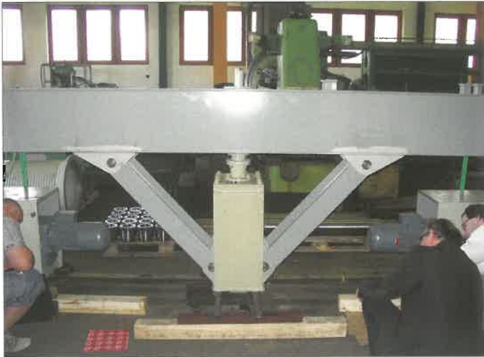
12. ábra. A síngógó beépítése és hajtása
