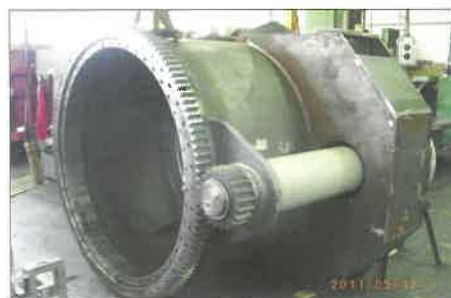
16.2. ábra. A golyóskoszorú és a bolygókerék-tengely gyári beállítása
