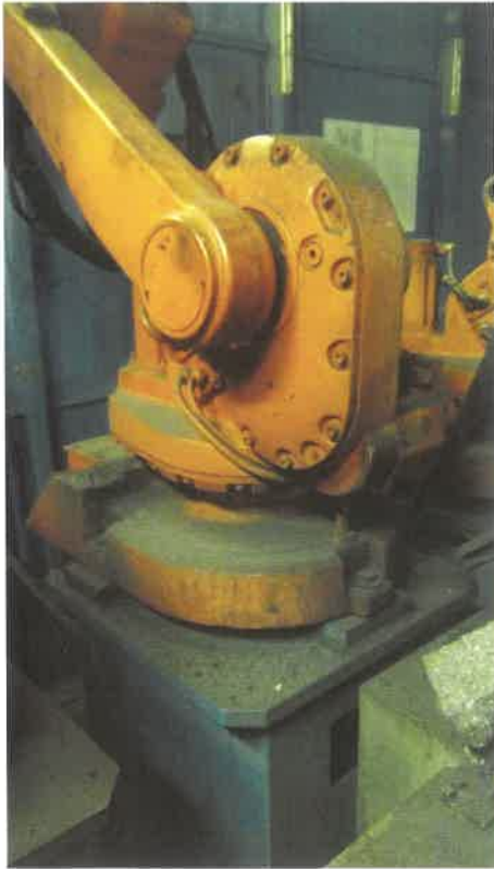
8. ábra. Hegesztőrobot tisztítás előtt (a), majd tisztítás után (b)
