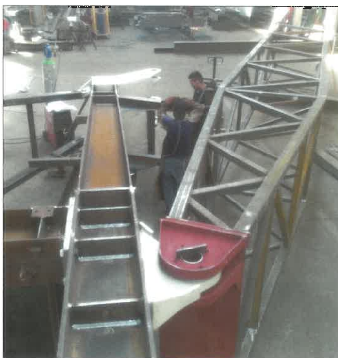
22. ábra. Toronyállvány és gém csatlakozásának előszerelése
