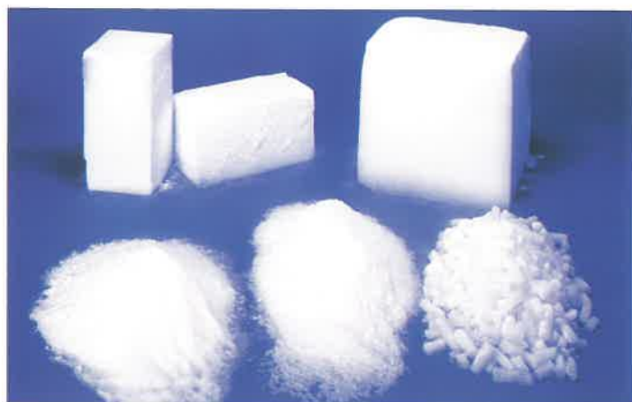
2. ábra. A szárazjég gyártási, szállítási formái (felső sor: különböző méretű blokk jég, alsó sor balról: szárazjég hó, pellet, nugget.)
