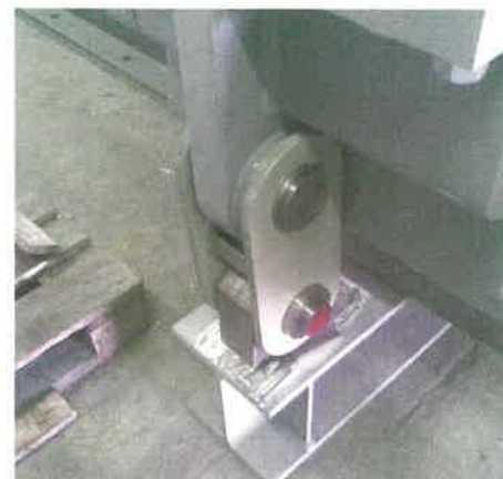
18. ábra. Túlterhelés-gátló mérőcsapjának beépítése a hajtómű-kikötésbe
