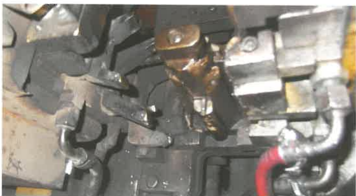
7. ábra. Hegesztő készülék állapota tisztítás előtt (a), és után (b)
