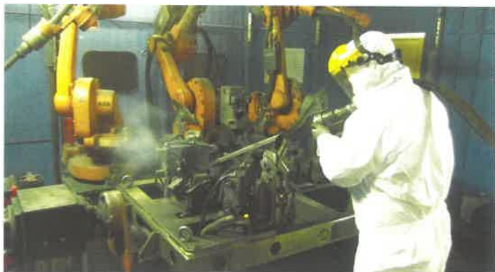
5. ábra. Hegesztőkészülék szárazjeges tisztítása a Gestamp Hungária Kft-nél
