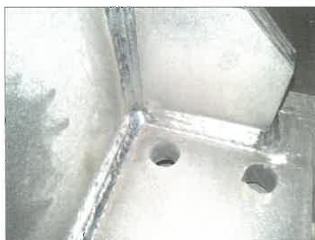
5. kép MAG hegesztés 82% Ar + 18% CO 2 védőgázzal
