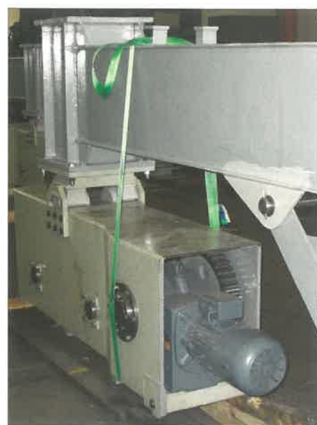
11. ábra. haladómű szerelés közben
