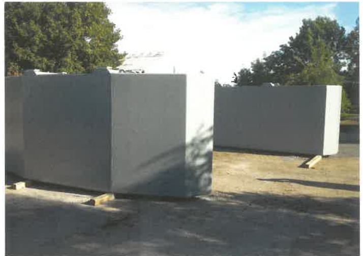
24. ábra. A 12 tonnás daru ellensúlyai
