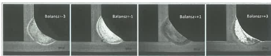
9. ábra Balansz hatása a beolvadására sarokvarratok esetében PB pozíció, lv = 2 \text{ mm} , saját mérési sorozat
