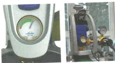
7. ábra. A szelepbe épített töltöttségjelző, egy manométeres nyomásszabályzó alkalmazása
