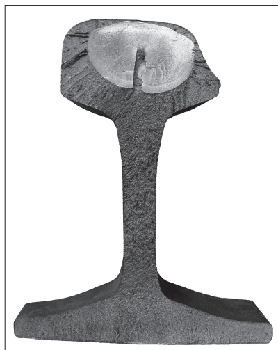
1. ábra. Vese típusú sínhiba
