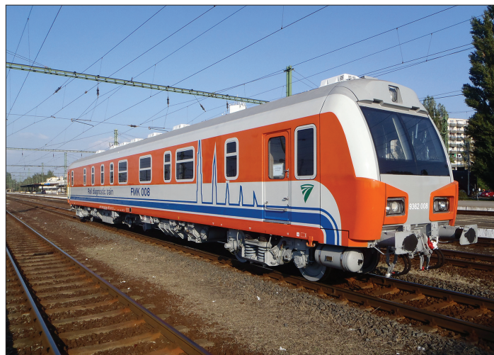
6. ábra. FMK-008 Sindiagnosztikai mérővonat
