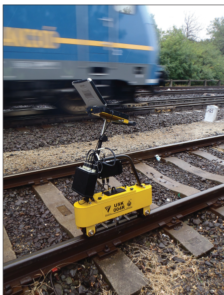
10. ábra. USK-002 és USK-004R típusú kézi ultrahangos sínvizsgáló készülékek
