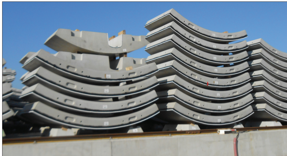
20. Betonnal kiöntött tűbbing-elemek
