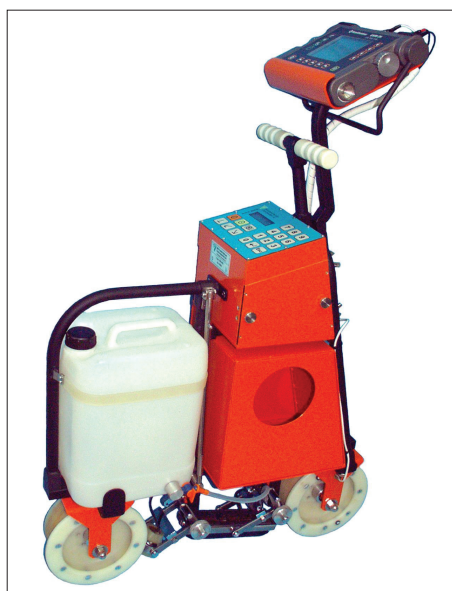
10. ábra. USK-002 és USK-004R típusú kézi ultrahangos sínvizsgáló készülékek
