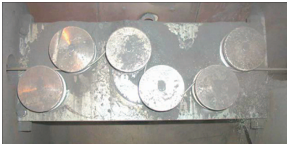
3. ábra: Huzalhajtogató revétlenítés berendezése [1]
