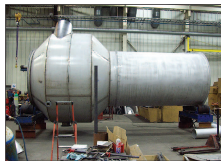
2. ábra A HÉDINN főépülete légkörkorrózió-álló acélból, és egy épülő, rozsdamentes acél reaktortartály
