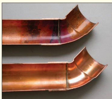
14. ábra. Keményforrasztott rézcső belső felülete a forrasztási technológia után (felső kép „gyökvédelem”/öblítés nélküli technológia, alsó nitrogén öblítés alkalmazásával)
