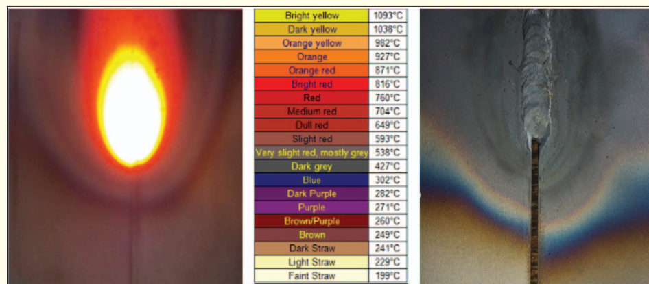
9. ábra. Lánghegesztési folyamat a hegesztés közben a felhevült terület színeinek hőmérséklet értékével, valamint a kihűlt munkadarab a futtatási színekkel.
