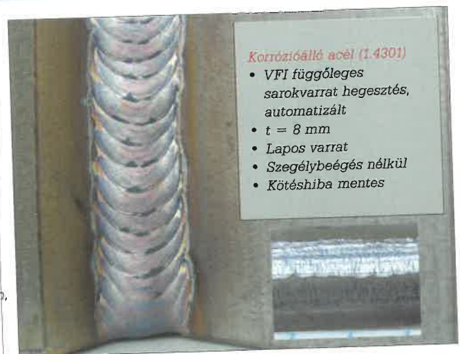
5. ábra Az új eljárásvariánssal készített automatizált függőleges varrat hegesztési mintája (X 5 CrNi 18-10 (1.4301) korrózióálló acél, lemezvastagság t=8 mm, védőgáz 98% Ar + 2% CO 2 , ER308 (1.4316) huzalelektroda 1 mm átmérővel)
