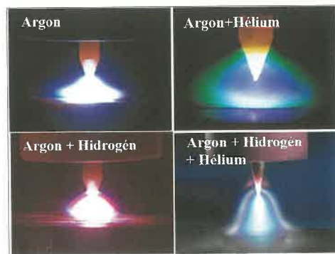
5. ábra: Különböző védőgázok által okozott színeltérés TIG eljárás elektromos ívéből [3], [4]
