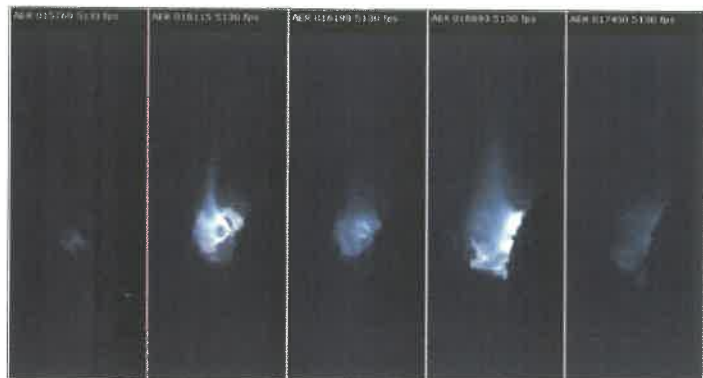
11. ábra Automatizált függőleges varratos hegesztés az új eljárásvariánssal (paramétereket lásd 10. ábra) – Az eljárás különböző időpontjaiban történt részletes felvételek balról jobbra: (1) A kisenergiájú intervallum vége, (2) pulzáló cseppleválás, (3) szekunder szerkezeti anyagátmenet „SpeedPulse”-nál [3], (4) hosszú, széles ív a szélbeolvadásra, (5) a nagy energiájú intervallum befejezése (utolsó csepp) és az alacsony energiájú intervallum kezdete.
