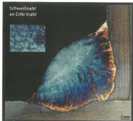
9. ábra Az SLV Fellbach vizsgálati eredményei a varrat területe szerkezeti struktúrájára vonatkozóan a függőleges sarokvarrat hegesztésénél az új eljárásvariánssal
