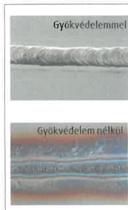
13. ábra. A lyukkorrózióval szembeni ellenállás változása a varrat mellett felhevült „hőhatásövezet” mentén
