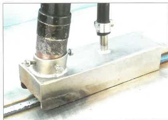
16. ábra. A gázvédelem kiterjesztésének lehetősége a varrat, hőhatásövezet hatásos védelme érdekében.
