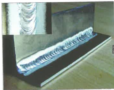
6. ábra Kézzel az új eljárásvariánsnal végzett függőleges varrat hegesztés mintája (Alumínium, lemezvastagság 3 mm, védőgáz 100% Ar, AISi5 huzal 1,2 mm átmérővel, huzal előtolási sebesség 4 m/min, hegesztési sebesség 42,6 cm/min, hegesztőáram 100 A, ív feszültség 17 V, hőbevitel 2,6kJ/cm)
