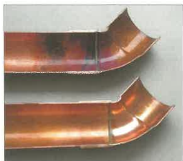
14. ábra. Keményforrasztott részcső belső felülete a forrasztási technológia után (felső kép „gyökvédelem”/öblítés nélküli technológia, alsó nitrogénos öblítés alkalmazásával)
