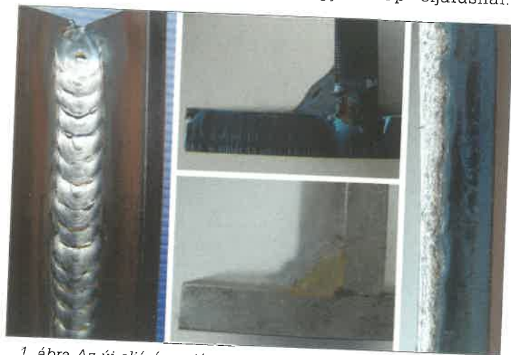
1. ábra Az új eljárásvariánshoz készült alkalmazási tanulmány egy kiváló minőségű hegesztési varratot mutat (S235JR acél, lemezvastagság 5 mm, védőgáz 82% Ar + 18% CO 2 , G3Si1 huzalelektroda 1 mm átmérővel huzalelőtölési sebesség 4,4 m/min, hegesztési sebesség 20,3 cm/min, hegesztő áram 108 A, hegesztési feszültség 18,2 V, hőbevitel 7 kJ/cm).
