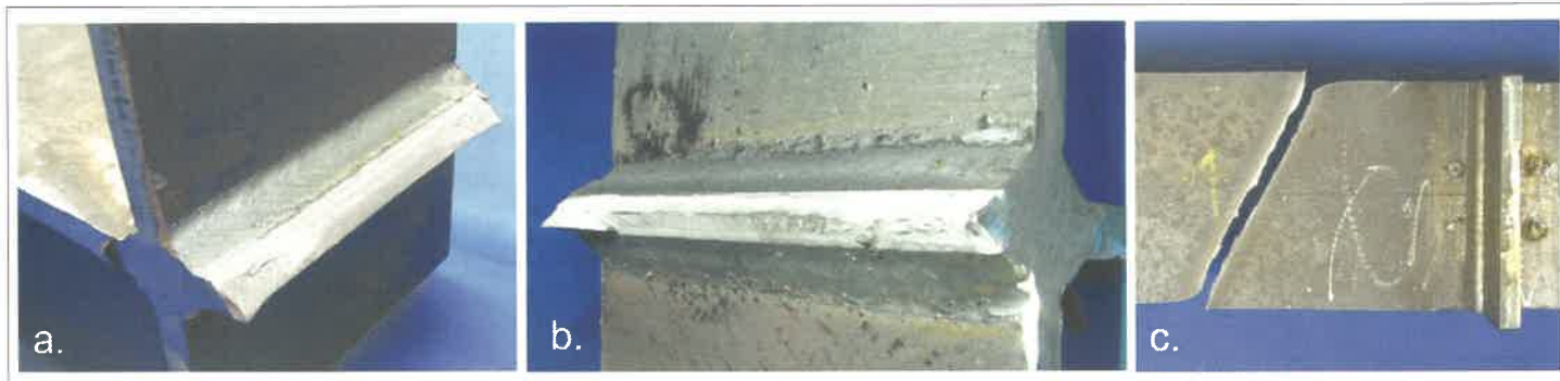
18. ábra. A nem teherviselő hegesztett kötések tönkremeneteli módjai
