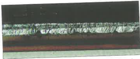
3. ábra X 5 CrNi 18-10 korrózióálló acél (1.4301) (lemezvastagság 4 mm, TIG hegesztőpálca ER308 1 mm átmérővel) PG helyzetben hagyományos impulzus ívvel (110 A, 22V) hegesztve; a hegesztési varrat kívül optikailag rendben volt, belül azonban jelentős kötési hibákat mutat.
